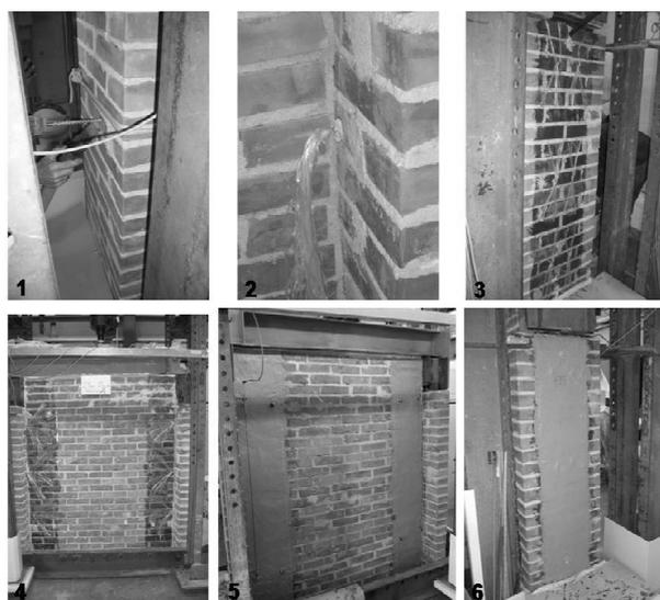
**Figura 3.26.** Fasi di realizzazione della connessione tra parete centrale e ali.
