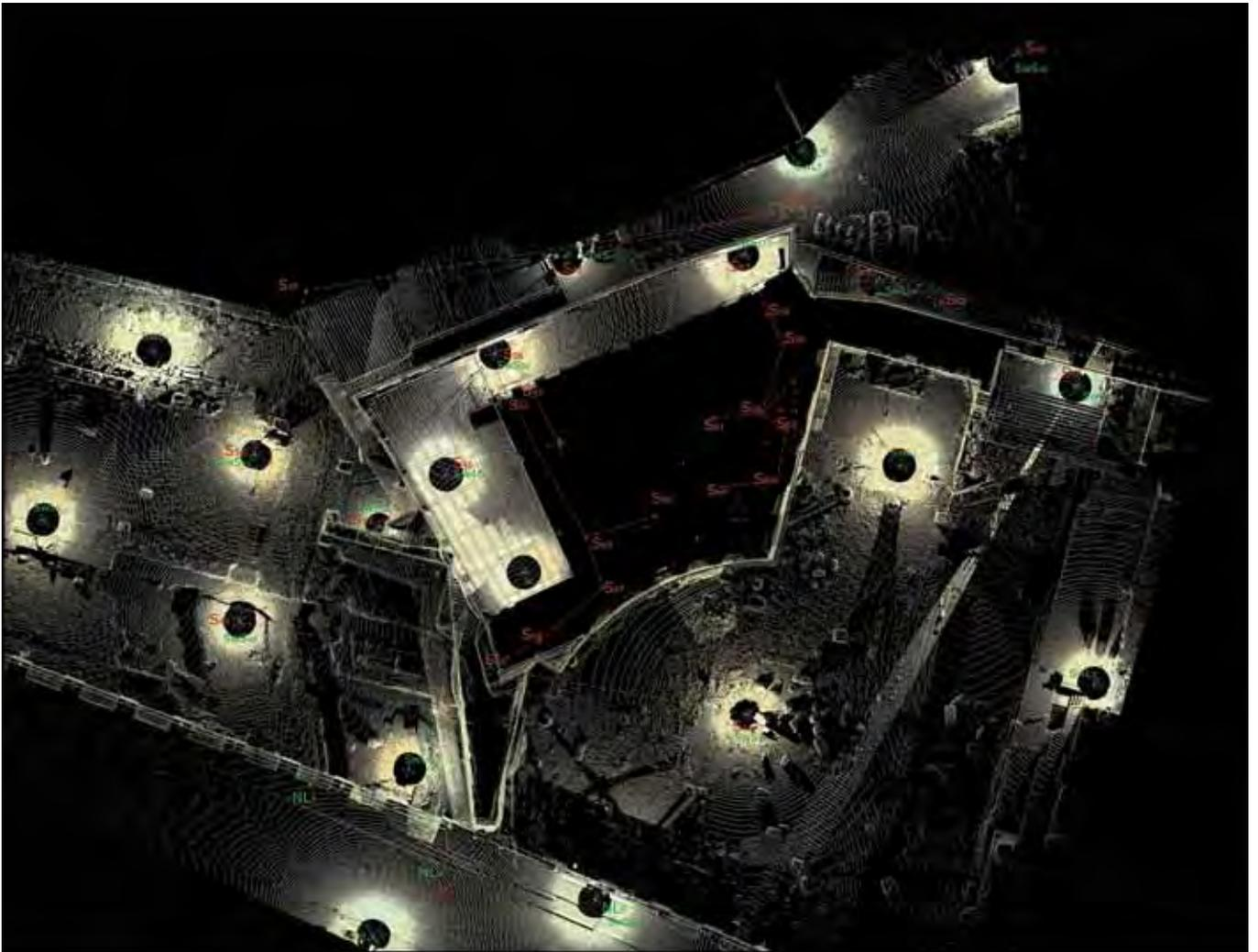
Fig. 2.57 – Rilievo geometrico. Restituzione della metodologia di rilevamento attuata: scansioni laser, pianta al livello della loggia.
