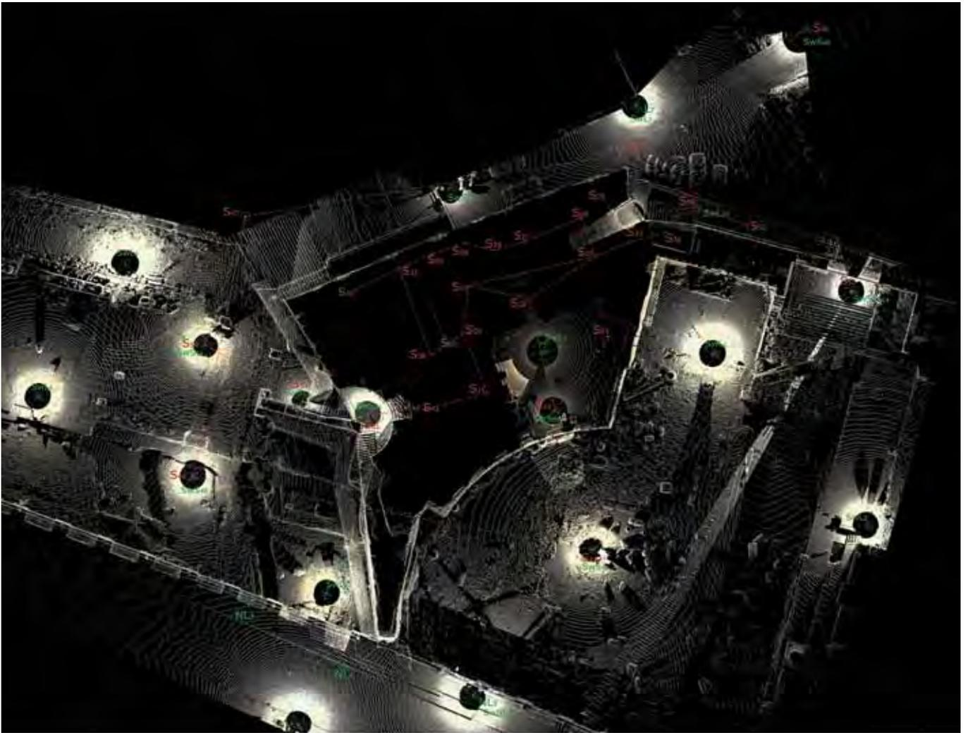
Fig. 2.55 – Rilievo geometrico. Restituzione della metodologia di rilevamento attuata: scansioni laser, pianta al livello dell'atrio.
