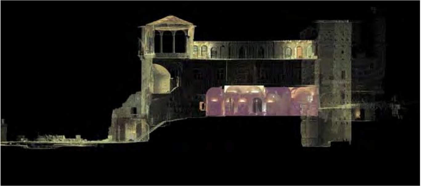
Fig. 2.47 – Immagine della nuvola di punti sezionata. Appare evidente come le scansioni eseguite con differenti strumenti e parametri di scansione possano avere una densità diversa. Ciò che differisce è anche la qualità del dato RGB dei punti, modificandosi l'apparecchio fotografico all'interno dello strumento.
