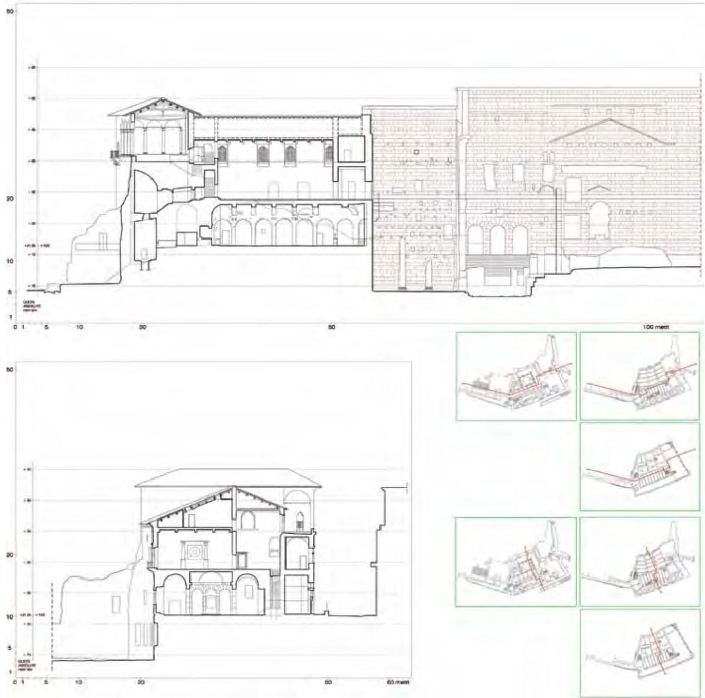
Figg. 2.94-2.95 – Rilievo architettonico. In alto, la sezione longitudinale e in basso quella trasversale. Si è scelto di ripercorrere i tagli operati da Gismondi prima e da Fiorini poi. Questo per poter confrontare gli elaborati nell'individuazione delle modifiche dell'assetto dell'edificio nel tempo.
