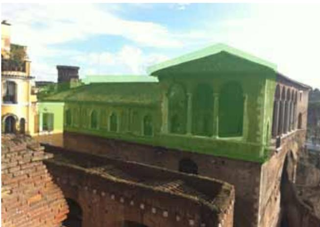
*Figg. 2.37-2.39 – Progetto di rilievo. Schemi organizzativi delle scansioni con indicazione dei volumi da scansionare, porzioni di architettura archeologica, il substrato archeologico, o elementi decorativi, con evidenziazione delle problematiche – tra cui la passerella che produrrà carenza di dati e la distanza che potrebbe rivelarsi eccessiva – degli elementi decorativi dalle diverse posizioni dello scanner.*
