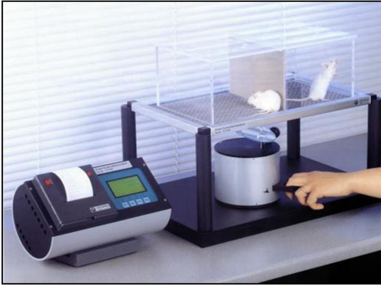
Figura 8. Dynamic Aesthesiometer Plantar test (Ugo Basile, Italia).
