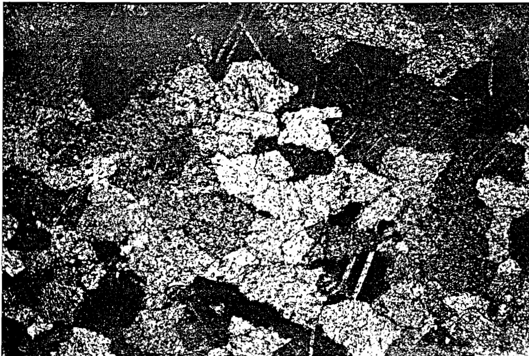
Fig. 6.2 - Sezione sottile del marmo a nicols incrociati (75 x)
