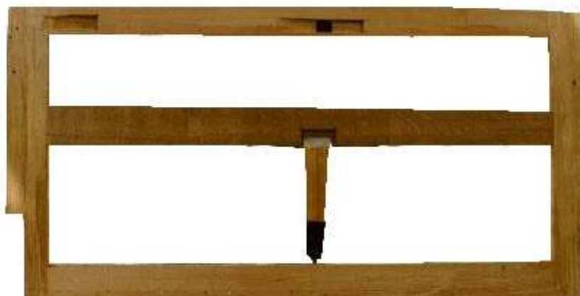
Il telaio della tastiera. Al centro è imperniata la leva che spinge verso l'alto la lista per il sollevamento degli smorzi
