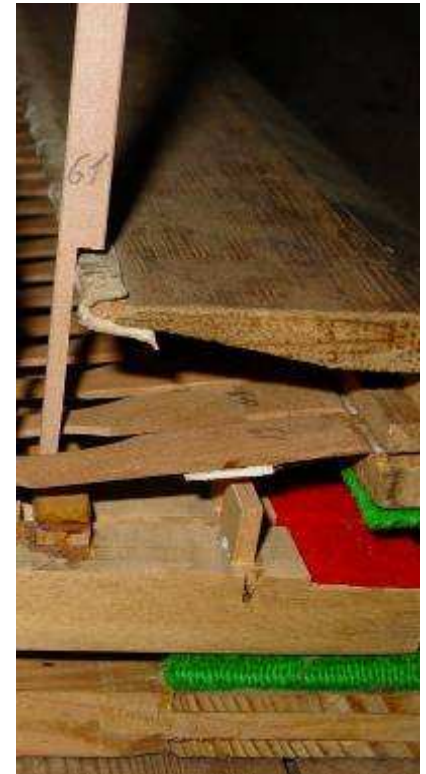
Visione del piede di uno smorzatore nel Tangentenflügel-clavicembalo di Sauer del 1786. Le leve intermedie di questo pianoforte presentano una forma differente da quelle degli strumenti di Späth e Schmahl
