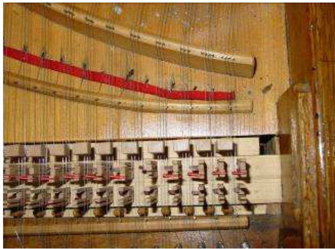
Particolare dei registri per i percussori e i due salterelli. In fondo la lista degli smorzatori del pianoforte. Foto di Michael Latcham
