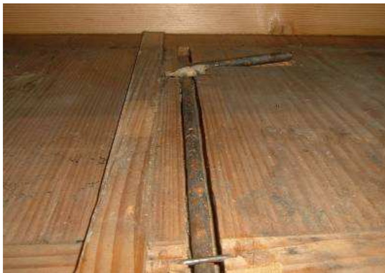
Fondo del vano tastiera: la barra metallica, mossa da una ginocchiera, solleva la leva posta sotto il telaio della tastiera (vedi immagine sottostante) che, a sua volta, spinge verso l'alto la lista per il sollevamento degli smorzi
