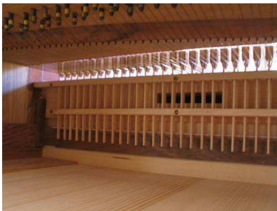
Visione dal basso dell'apparato smorzatore di un pianoforte di Silbermann del 1749 (copia di Ugo Casiglia, 2005). Gli smorzi, a cuneo, si sollevano simultaneamente per mezzo della barra che li sostiene
