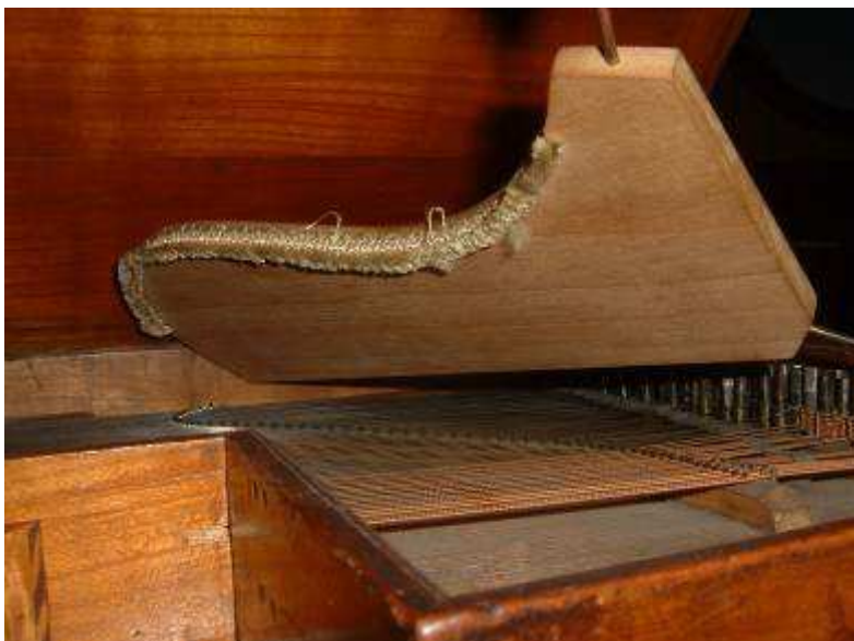
Harfenzug di un piccolo pianoforte a tavolo con Prellmechanik di Johann Andreas Mahr, 1805 (Deutsches Museum, Monaco, n. inv. 1909-20781)
