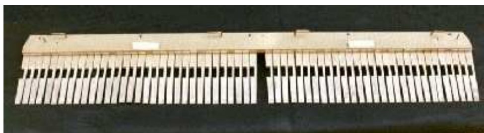
Leve intermedie di un Tangentenflügel di Schmahl del 1797
