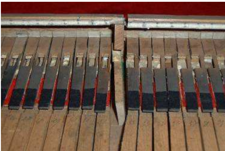
Particolare dello spingitore che consente il sollevamento della lista che sostiene gli smorzi.
