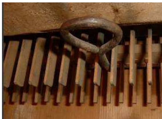
Visione degli spingitori che azionano gli smorzi (fila anteriore) e i percussori (fila posteriore)
