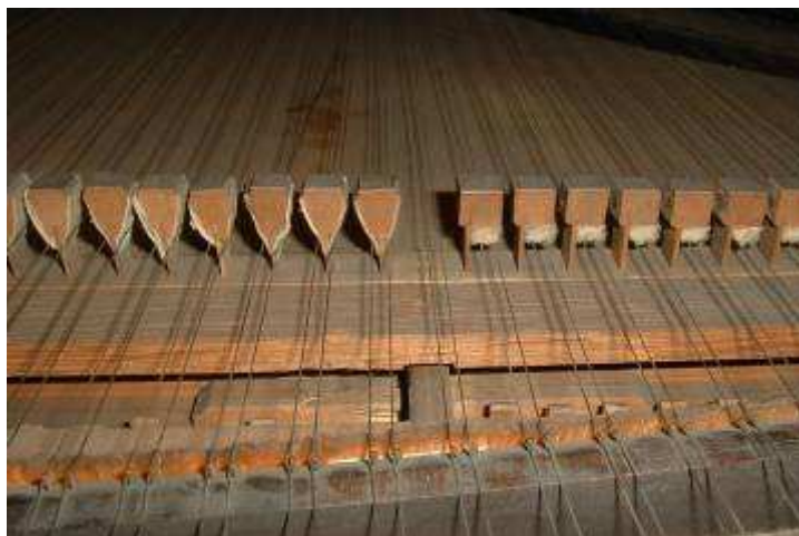
Visione frontale delle due tipologie di smorzatori in una Tangentenflügel di Schmahl della prima metà degli anni '90
