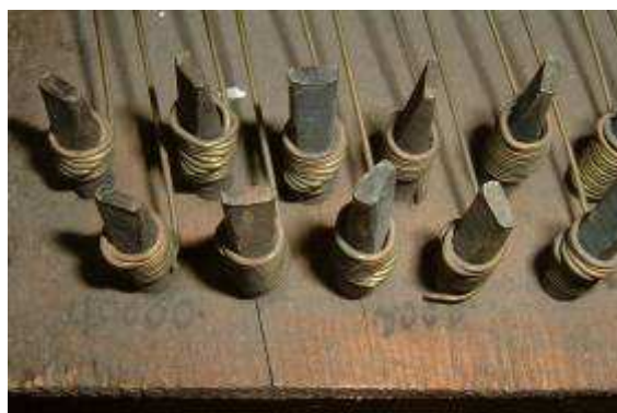
Iscrizioni su somiere per i diametri delle corde
