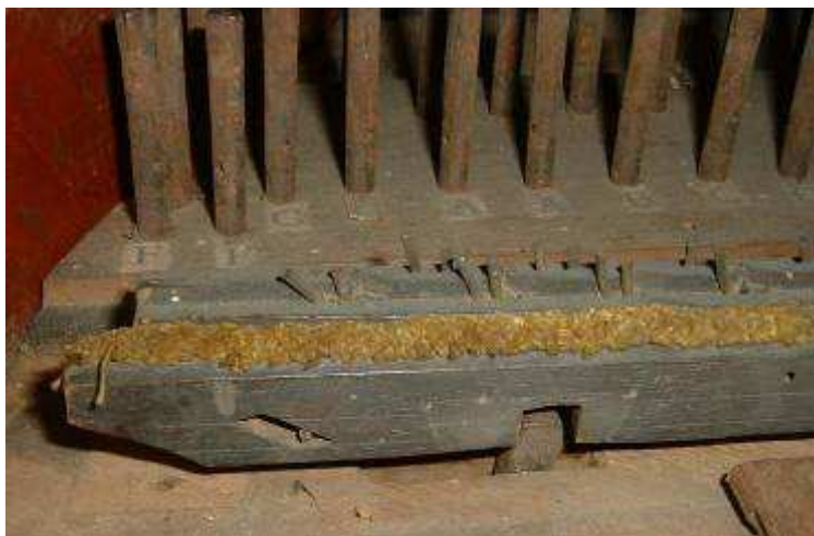
Dispositivo d'arpa di un pianoforte a tavolo con martelletti non imperniati, Italia inizio XIX secolo (Collezione "Ad Libitum", Etobon)
