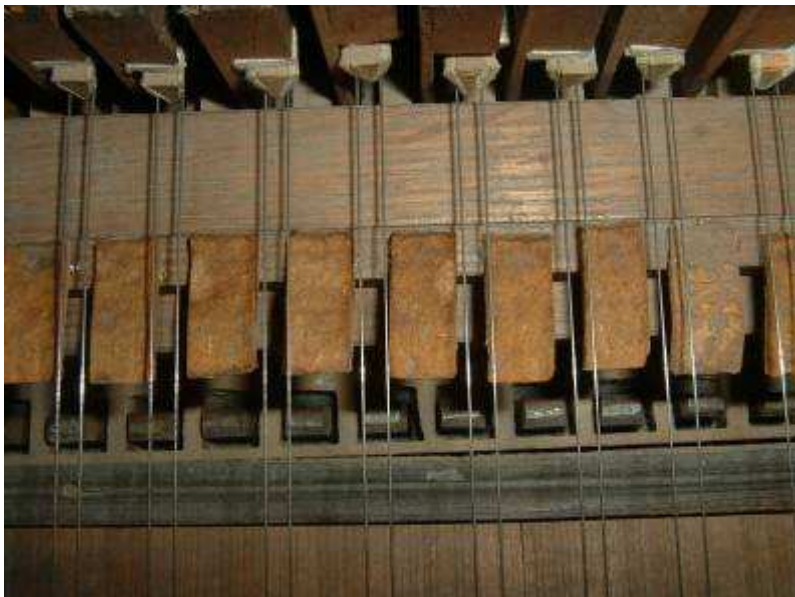
Particolare del moderatore di un Tangentenflügel di Schmahl del 1800. Le linguette di pelle attutiscono il suono qualora frapposte tra i percussori e le corde
