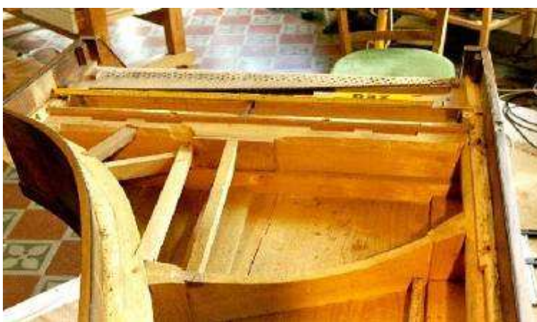
Particolari della costruzione interna di un Tangentenflügel del tipo corto di Schmahl del 1797 (Collezione privata, Svizzera)
