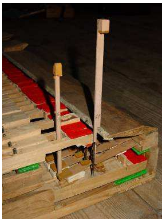
Visione laterale della parte posteriore delle due tastiere. Su quella inferiore poggiano un percussore e uno smorzo
