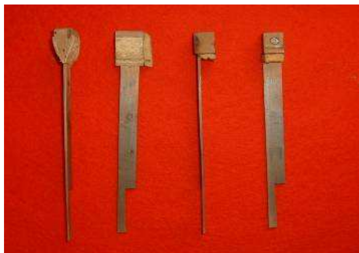
Le due tipologie di smorzatori (visione frontale e laterale). Si noti l'asticciola "a gradino"
