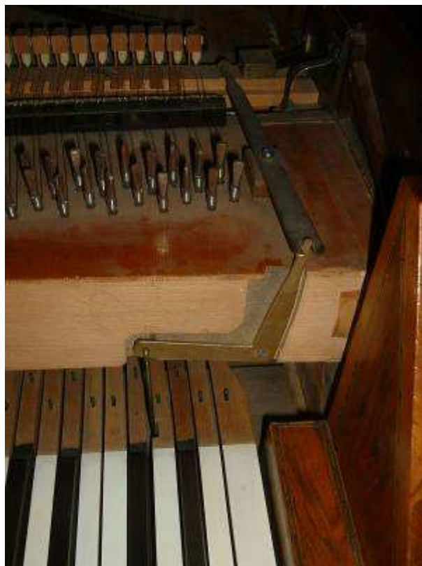
Particolare del dispositivo che, comandato da una ginocchiera, inserisce il moderatore in un Tangentenflügel di Berner del 1798
