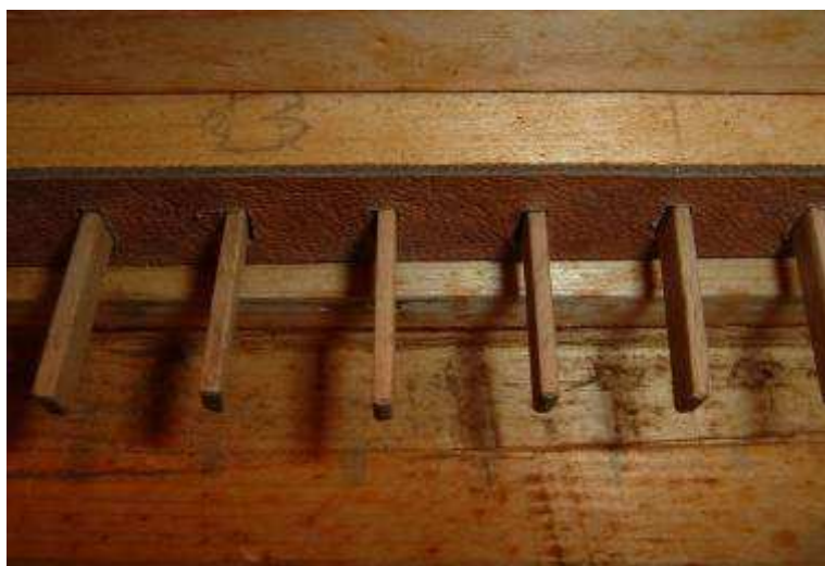
Percussori non imperniati in un pianoforte di costruzione siciliana. All'estrazione della tastiera essi pendono dalla lista guida nella quale sono inseriti
