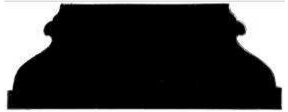
Profilo del supporto modanato per la barra di copertura degli smorzi.
