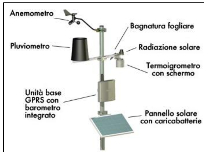
Fig.127. Tipologia di centralina meteosolare GPRS
