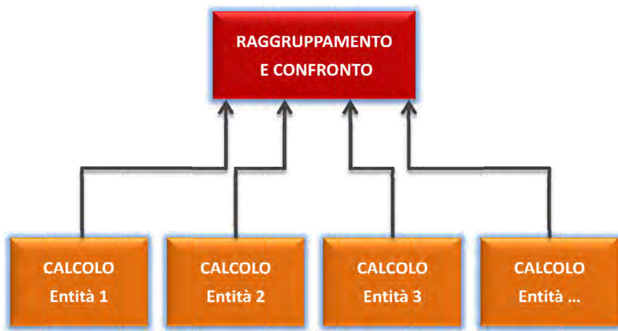
Fig. 3.3.1. Diagramma logico della struttura generale del sistema di calcolo. Ogni riquadro è un file. I riquadri in basso rappresentano i file di calcolo che sono tutti uguali a meno dei dati inseriti. Il riquadro in alto rappresenta il file di raggruppamento e confronto, unico per ogni progetto.
