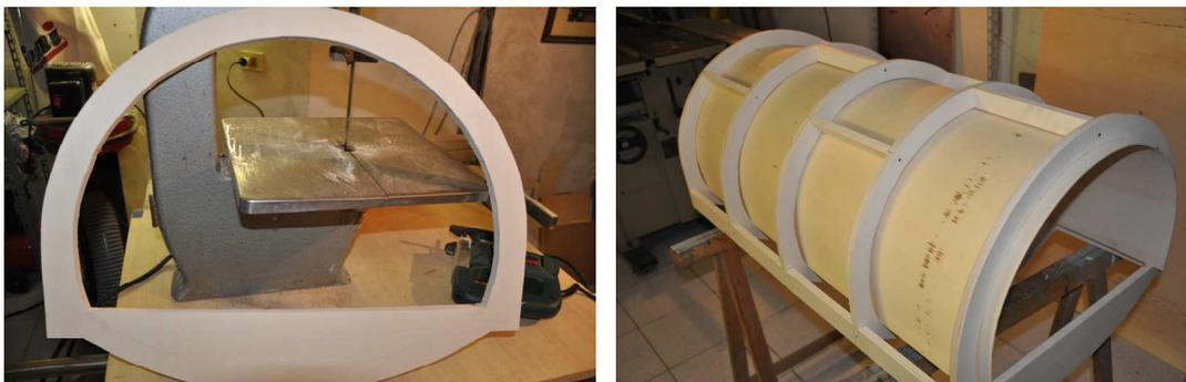
**Figura 3.1 – Modello di galleria in costruzione.**
