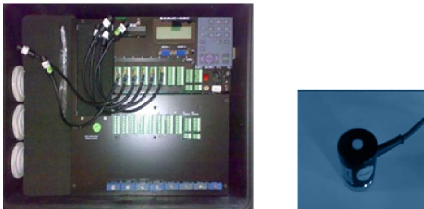
**Figura 3.5 – Strumentazione di misura dell'illuminamento: Babuc ABC (a sinistra) e sonda luxmetrica (a destra).**
