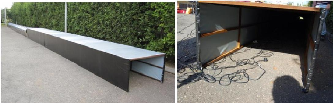
**Figura 3.17 – Modello in scala 1:10 di una galleria e di una pregalleria.**
