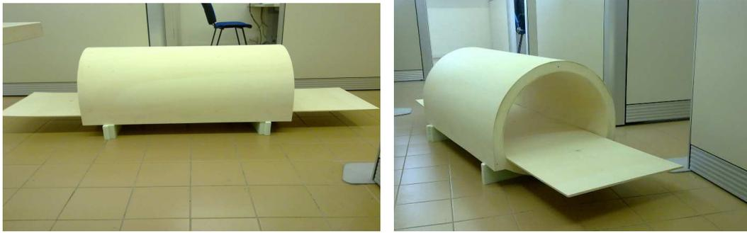
**Figura 3.2 – Modello di galleria in scala 1:20.**
