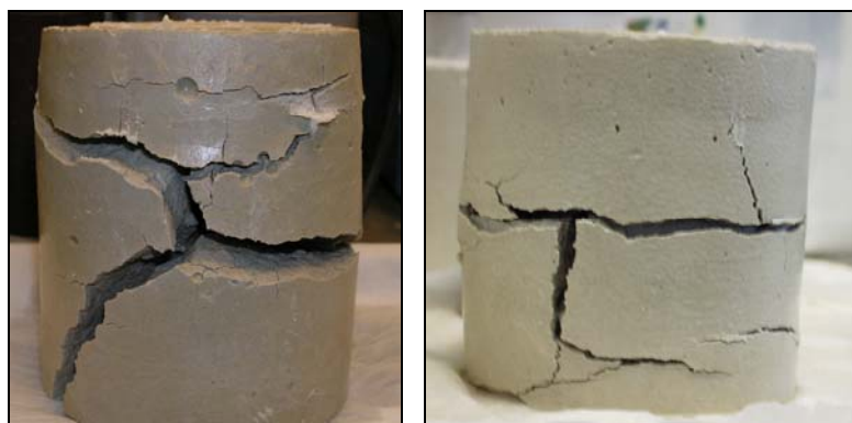
Figura 2.56 – Effetto sulle miscele terreno-cemento dell'attacco dei solfati (Osman, 2007).
