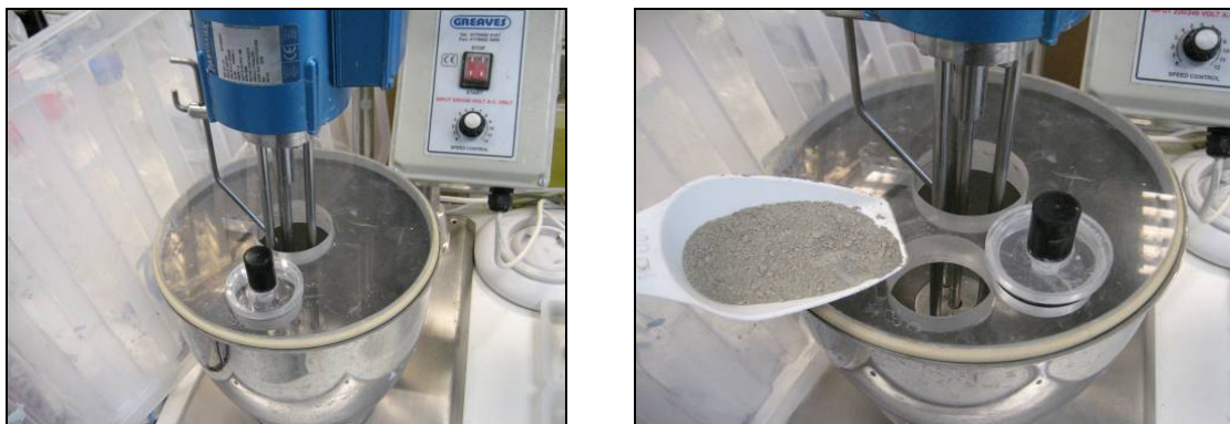
Figura 3.16 – Fasi della miscelazione con High Shear Mixer.
