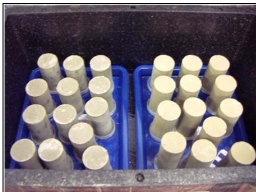
Figura 3.51 – Riposizionamento dei provini nel contenitore per la maturazione.
