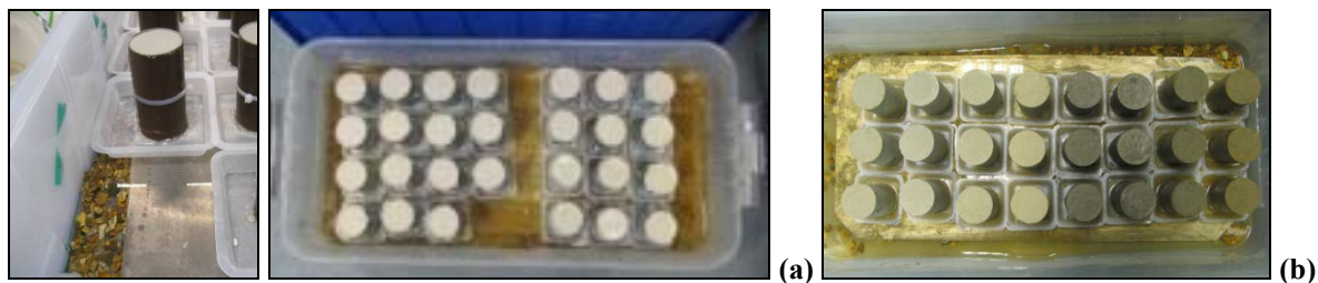
Figura 3.20 – Provini nei contenitori di maturazione; (a) terreni coesivi; (b) terreni granulari.
