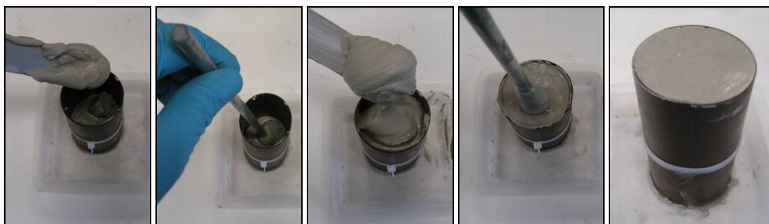
Figura 3.19 – Confezionamento di provini mediante compattazione dinamica.
