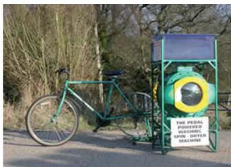
L'idea è molto semplice: una **LAVATRICE AZIONATA DA UNA BICICLETTA** per un progetto “fai da te” e open source (messo a disposizione dal designer online). Anche la lavatrice può essere realizzata in maniera non industriale, utilizzando legno o metallo. È un progetto che unisce due necessità: quella di fare sport e quella di lavare i panni sporchi in maniera efficiente e senza troppo spreco di acqua.
