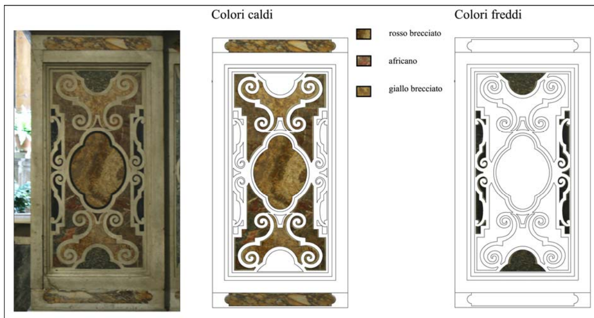
Dis. 11 – Cappella di Santa Maria di Loreto in Sant’Onofrio al Gianicolo. Particolare del basamento nella zona d’accesso (foto e dis. dell’A.)
