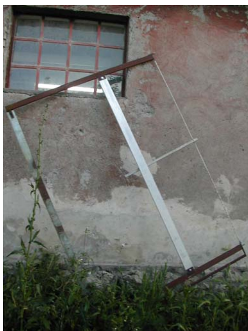
Fig. 6 – Sega a mano per tagli artigianali da impiegare con polvere di smeriglio (foto dell'A.)
