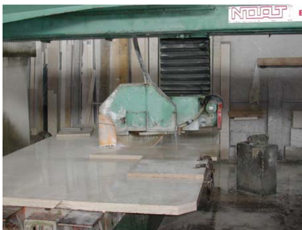
Fig. 7 – Strumento computerizzato per il tagli di lastre marmoree di qualsiasi forma e dimensione (foto dell'A.)
