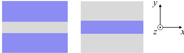
Figura 1.9. Slab plasmonico immerso in dielettrico (sinistra) e slab dielettrico rivestito di strati metallici (destra). Le regioni in blu rappresentano il dielettrico, mentre quelle in grigio il metallo.
