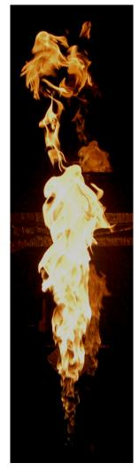
FIGURE 1.4. Turbulent Diffusion Flame
