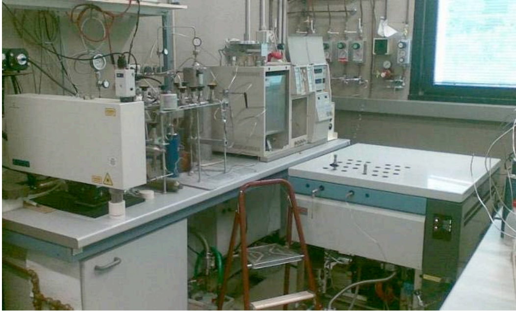
Figura 3. 15 Strumentazione utilizzata per le analisi. È visibile il cromatografo e lo spettrometro di massa ed esso collegato situato presso il Laboratorio di Isotopi Stabili, Istituto di Geoscienze e Georisorse (IGG) del CNR di Pisa.
