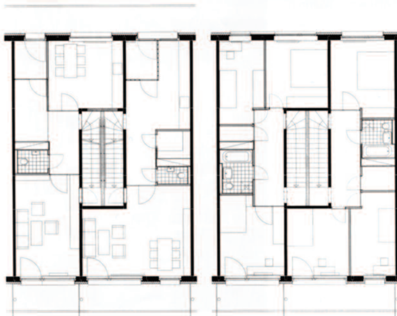
17 piante tipo del tipo "Laubengang" che crea appartamenti duplex accessibili prima dal nuovo scala dell'edificio costruito ex novo e poi attraverso i ballatoi
