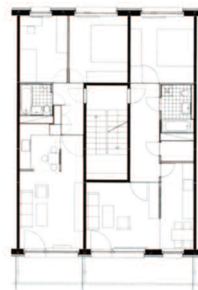
6 pianta tipo del modello di ristrutturazione tipo "Low", la cucina viene integrata con il soggiorno attraverso una parete scorrevole
