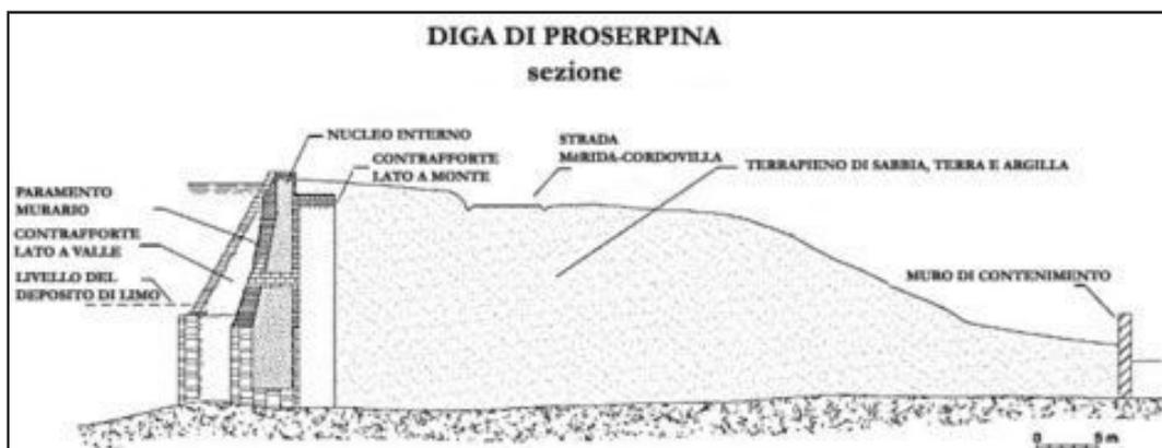
Fig. 26 Sezione della diga di Proserpina, Spagna (ARENILLAS PARRA 2002c, fig. 10).
