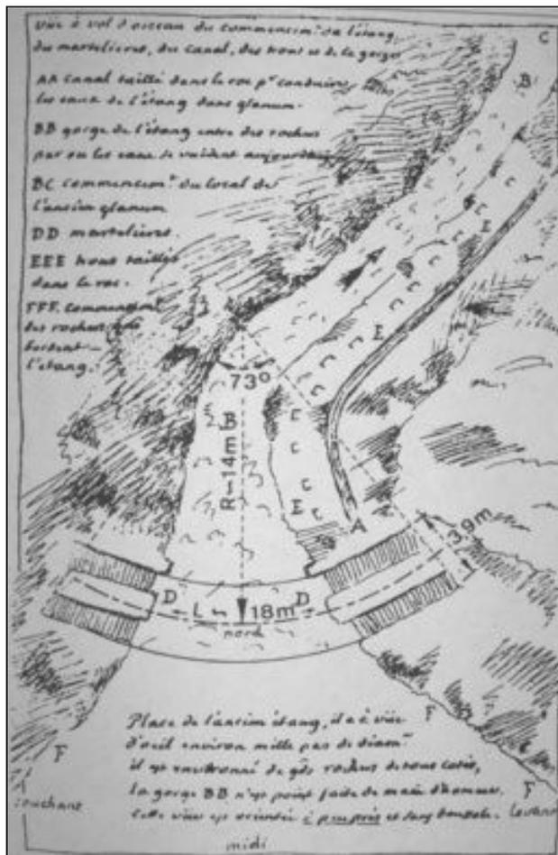
Fig. 31 Schizzo planimetrico della diga di Glanum, Francia (BENOIT 1905, p. 332).
