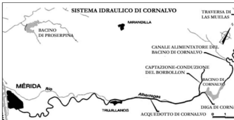
Fig. 10 Sistema idraulico di Cornalvo, Spagna (ARENILLAS PARRA 2002b, grafico I).
