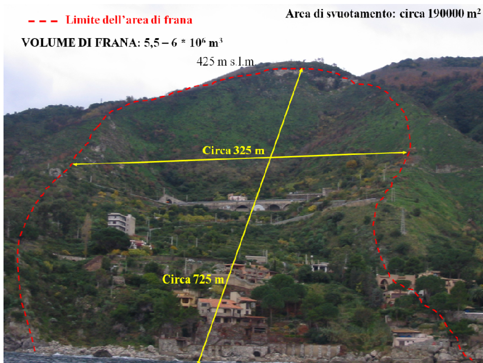
Fig. 2.25 – Area di frana del Monte Pacì vista da mare. Sono indicate le principali caratteristiche geometriche della frana stessa.
