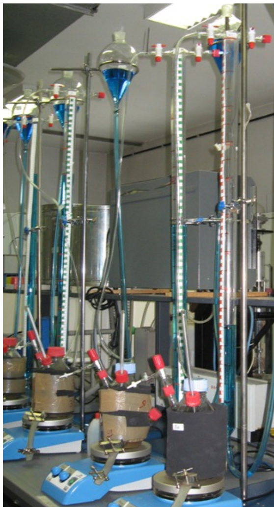
Figura 4.2 Reattori collegati ai rispettivi eudiometri
