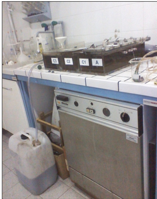
Figura 227 - Immagine del bio-reattore e dello scarico dell'effluente.
