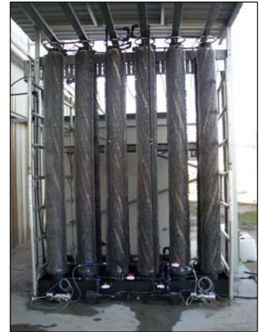
Figura 85 - Una fotografia della vista laterale dell'impianto, dalla quale si distinguono le 2 pompe, quella di ricircolo e quella di alimentazione poste alla base.
