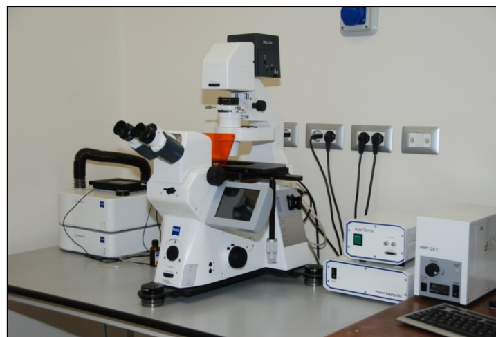
Figura 37 - Immagine del Microscopio a fluorescenza confocale per live imaging, al CNIS - Centro di Ricerca per le nanotecnologie Applicate all'Ingegneria a SAPIENZA.
