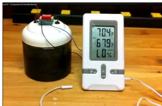
Figura 91 - MFC MudWatt mentre alimenta una stazione per il monitoraggio della temperatura e della pressione.
