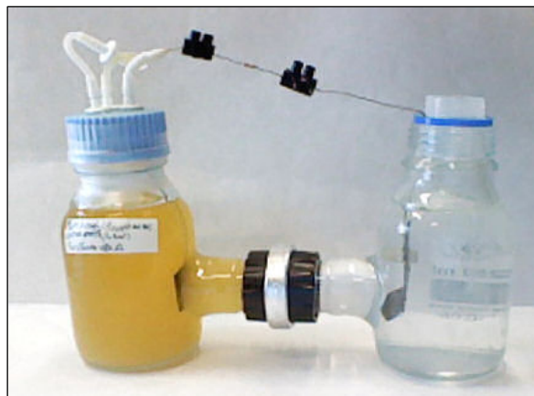
Figura 192 - Immagine della MFC bicamera con inoculo di Pseudomonas aeruginosa ceppo Pa01.
