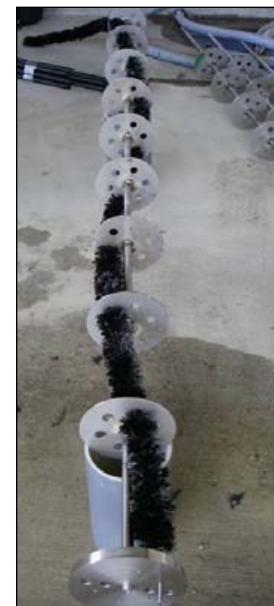
Figura 82 - Una spazzola montata sul suo sostegno in acciaio e che viene collegata al collettore dell'elettrodo anodico a forma di disco, di un singolo tubo.
