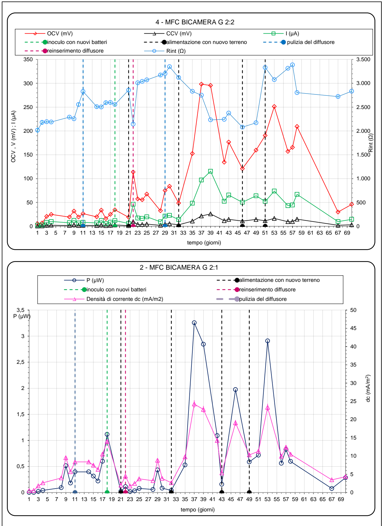
Figura 142 - Andamento delle grandezze elettriche per la MFC denominata G 2:1.
