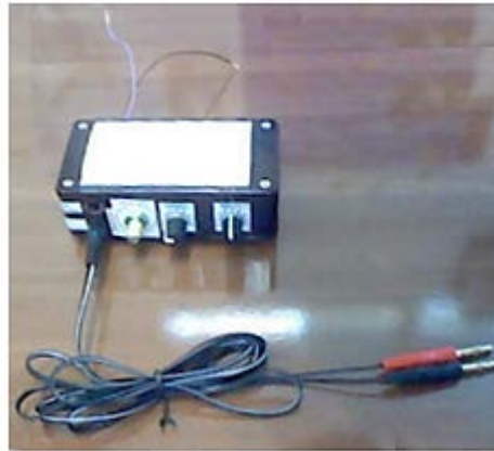
Figura 176 - Prima stazione di misura (0÷5 k \Omega ).
