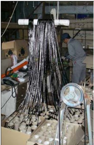
Figura 80 - Costruzione degli elettrodi anodici, con l'uso delle fibre di carbonio, ancora avvolte nei supporti di cartone e che costituiranno le spazzole.
