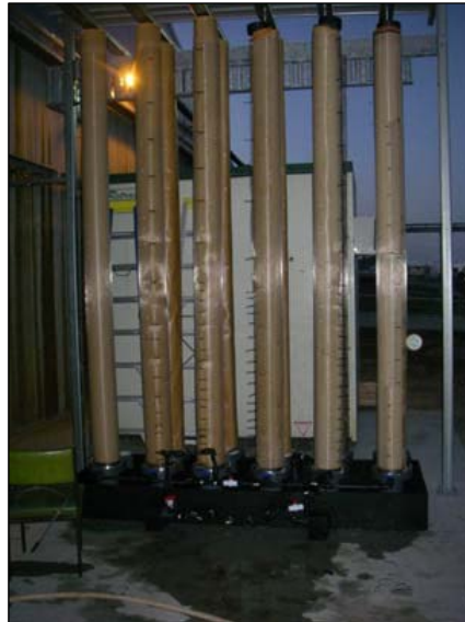
Figura 84 - Immagine con tutti i tubi già montati sui supporti comprensivi di elettrodi anodici ma mancanti di quelli catodici.
