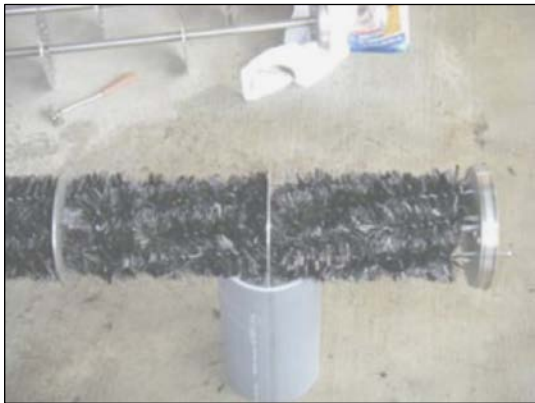
Figura 78 - Un elettrodo anodico completo di tutte le sue spazzole, in totale sono 6 per ciascun tubo.
