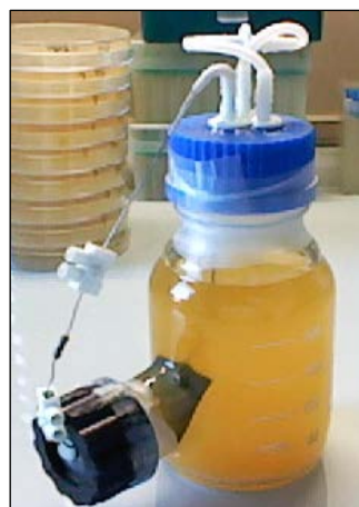
Figura 194 - Immagine della MFC Pseudomonas aeruginosa conservati in atmosfera d'azoto.
