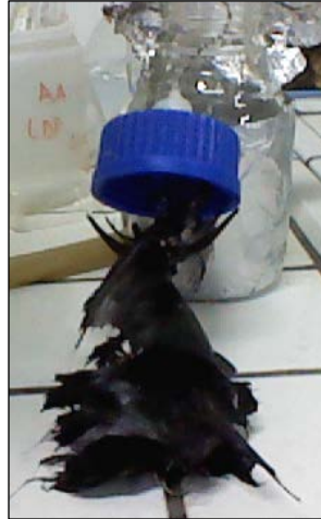
Figura 115 – Immagine dell'elettrodo a spazzola di grafite.
