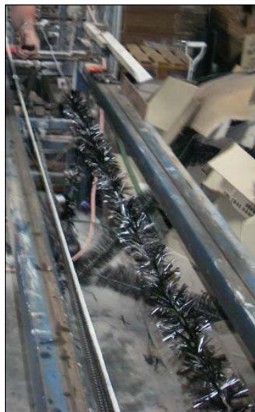
Figura 81 - Una singola spazzola che serve a realizzare l'elettrodo anodico di un singolo tubo.
