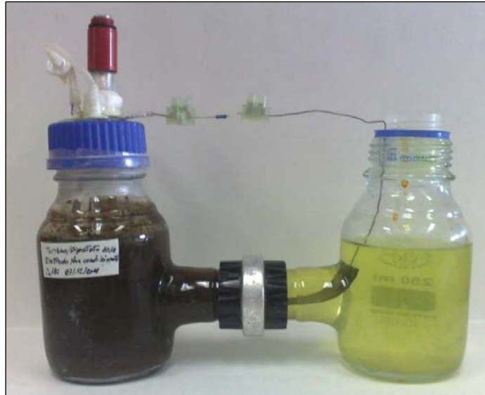
Figura 170 - MFC-U, non condizionata, con ferricianide come catolita.
