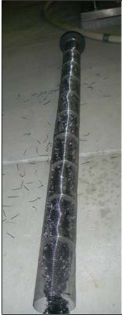
Figura 83 - Immagine dei 2 elettrodi di un singolo tubo, dove la rete esterna costituisce il catodo mentre le spazzole interne costituiscono l'elettrodo anodico.
