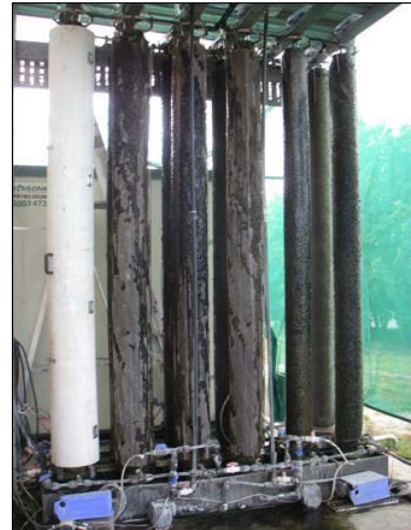
Figura 88 - Immagine che mette in luce gli elettrodi catodici, per 11 tubi mentre un solo tubo ha già il rivestimento esterno plastico di colore bianco.
