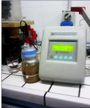
Figura 148 - Il pH-meter CRISON GLP 22 in fase di misura del pH in una MFC.
