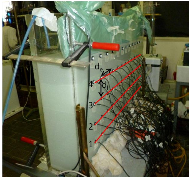
Fig. 4.25 - Vista posteriore della vasca. Si notano gli elettrodi inseriti nei fori della parete di fondo e i cavi che collegano gli elettrodi alla scatola dalla quale partono i multicomponente dello strumento. Con d_e si indica la distanza tra gli elettrodi e con d_l la distanza tra le linee. In rosso sono indicate le file di elettrodi utilizzate per l'esperimento.
