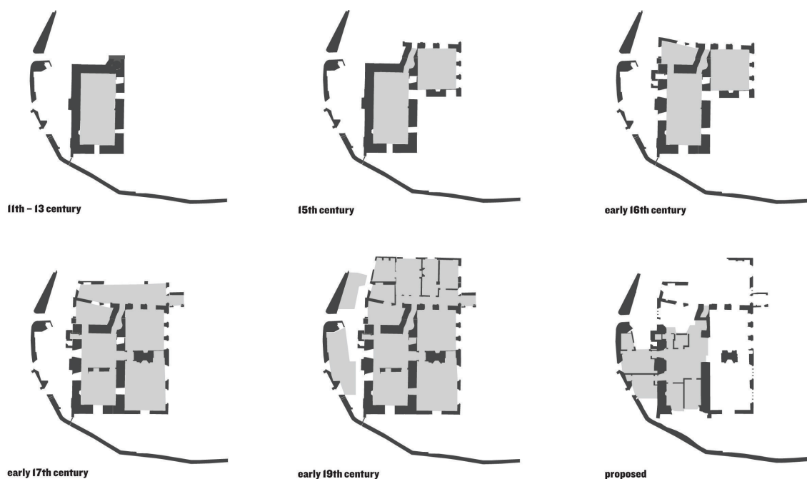
Fig. 5.60 Schematizzazione delle fasi costruttive legate alle vicende storiche del castello (immagini tratte da www.architectural-review.com ).
