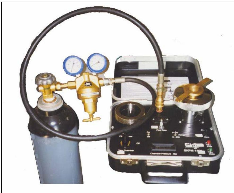
Fig. 8. Camera a pressione portatile (SKPM 1400, Skye Instruments, UK) collegata ad una bombola contenente una miscela di aria e azoto, utilizzata per le misure di potenziale idrico fogliare ( $\Psi$ ).
