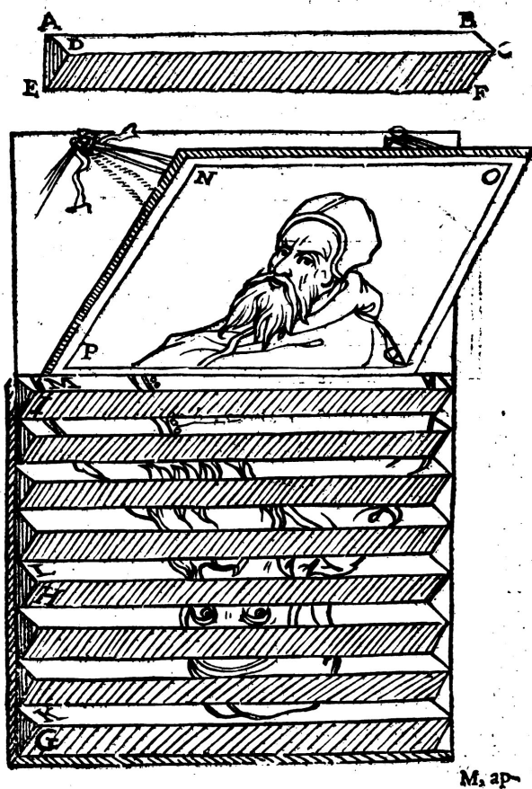
Fig. 21 – L'immagine originaria, suddivisa in fasce, è applicata sui lati di stecche prismatiche e riflessa su di uno specchio piano inclinato su di essa. Egnazio Danti, Commentari a Le Due regole della Prospettiva Pratica del Vignola , 1583, p.96.
