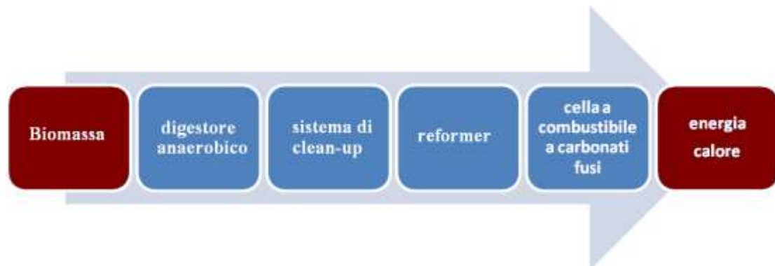
Figura1. Schema del impianto integrato per la produzione di bioenergia con le celle a combustibile
