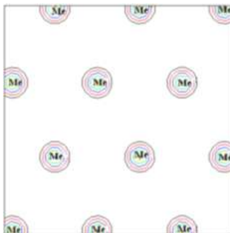
Figura10. Mappatura di Fourier lungo il piano cristallino 101 di Ce_{0.5}Zr_{0.5}O_2 . Me indica indistintamente Ce e Zr.
