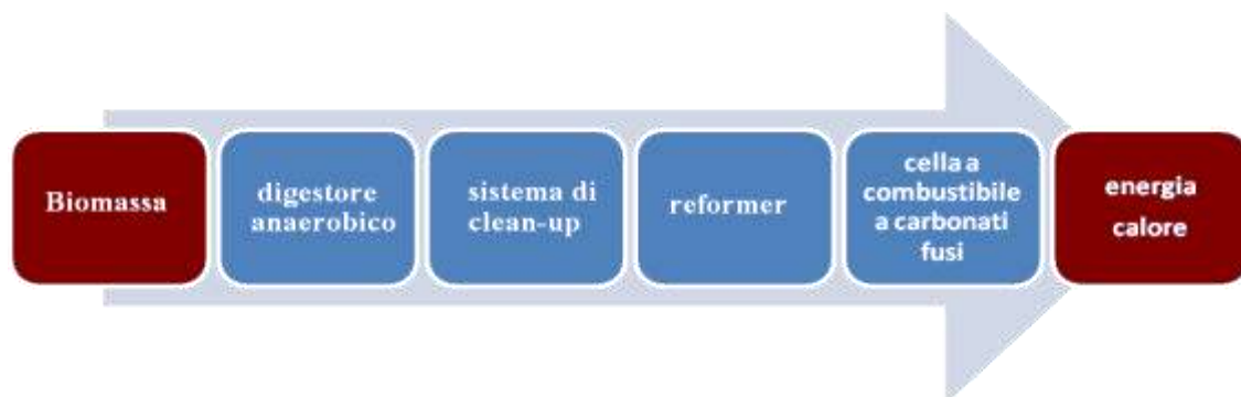
Figura2. Schema di un impianto integrato per la conversione elettrochimica da biomassa
