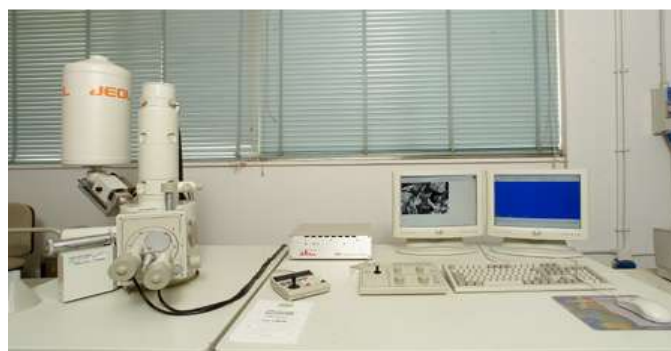
Figura7. Strumentazione di laboratorio usata per le analisi al SEM-EDX.
