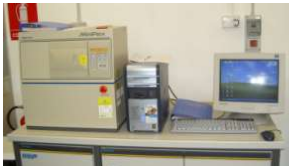
Figura6. Strumentazione di laboratorio usata per le analisi spettroscopiche XRPD.
