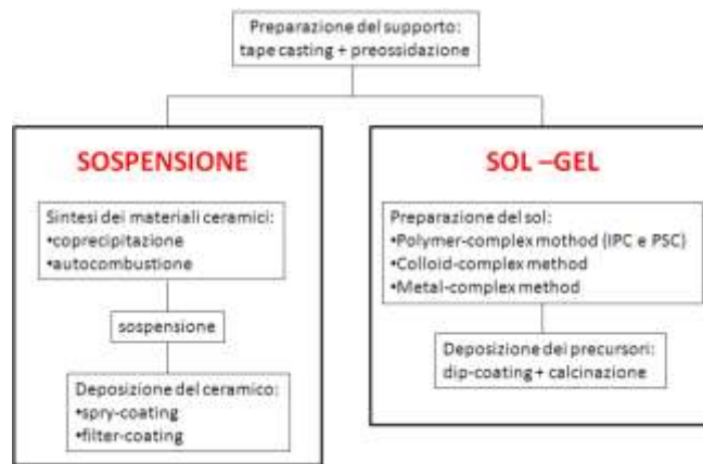
Figura1. Diagramma a blocchi che illustra la sequenza delle fasi per la produzione di un anodo innovativo. Sono evidenziate la fase di preparazione del substrato e le fasi di sintesi/preparazione del coating.
