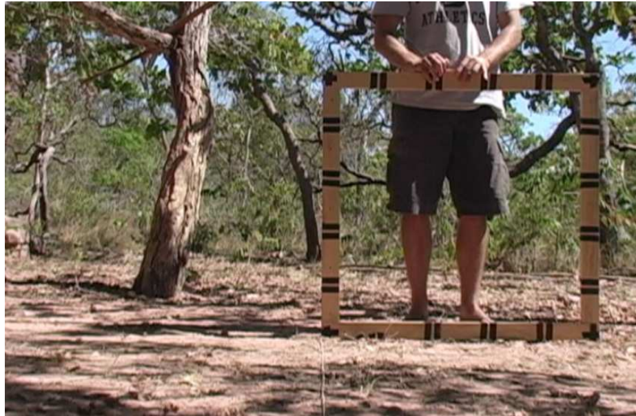
Fig. 4.5 La calibrazione spaziale avviene grazie ad un quadrato di legno di 1 m di lato su cui sono stati applicati marker neri posti a 20 cm di distanza uno dall'altro.
