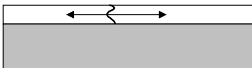
Figura 2.6 Frattura dovuta ad uno stato di tensione residua
