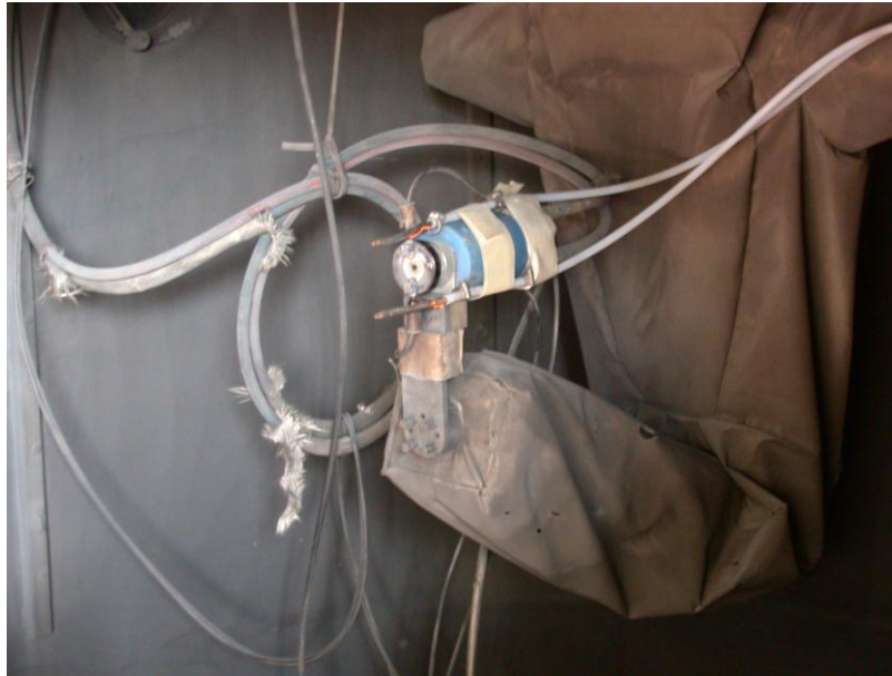
Figura 2.22 Braccio della Torcia al Plasma (impianto CAPS)
