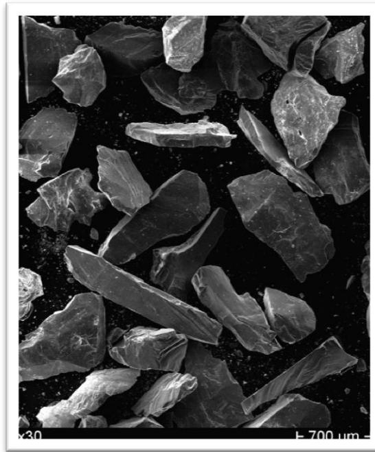
Figura 5.39 SEM-BSE silicio tal quale
