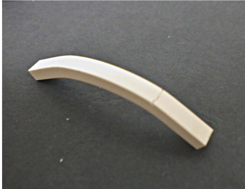
Figura 4.17 (a) campioni microstrutturati sottoposti a prova di flessione a 1500°C; (b) particolare di un provino
