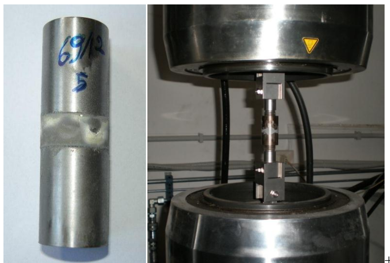
Figura 4.109 Campione incollato per le prove di adesione (sx) e montato su macchina di trazione uni assiale (dx)
