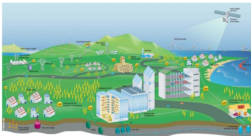
Fig. 3.2 – La visione europea per la trasformazione del sistema energetico: la smart grid è la rete connessa di una serie di distretti energetici integrati (power parks) autosufficienti dal punto di vista della generazione di energia localmente consumata
