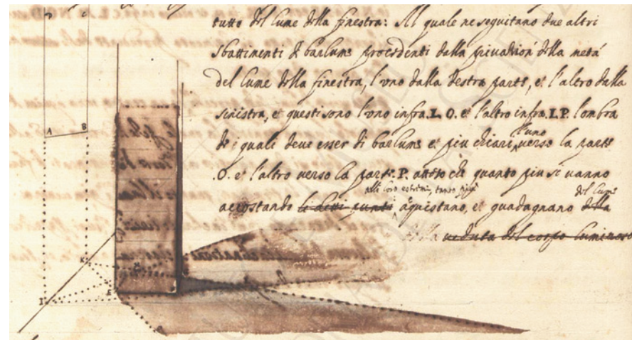
Fig. 71: L. Cardi detto il Cigoli, Prospettiva pratica di fra L. C. C. , Libro Secondo, quinta parte, pag. 79v. L'ombra e la zona di penombra di un parallelepipedo, poggiato a terra sulla base minore, sottoposto alla luce proveniente da una finestra in un interno.
