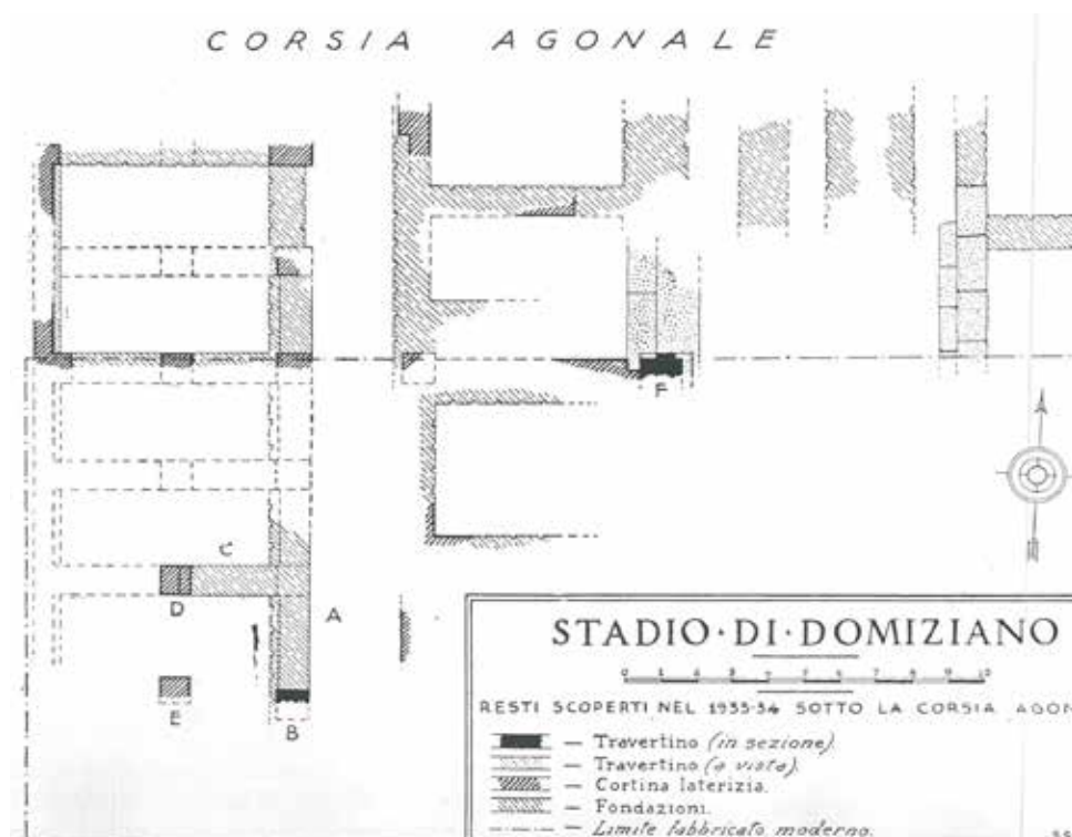
fig. 43 -Fondazioni e pilastri dello stadio venuti in luce durante i lavori della Corsa Agonale (G.GATTI, 1935- pubbl. in COLINI 1943)
