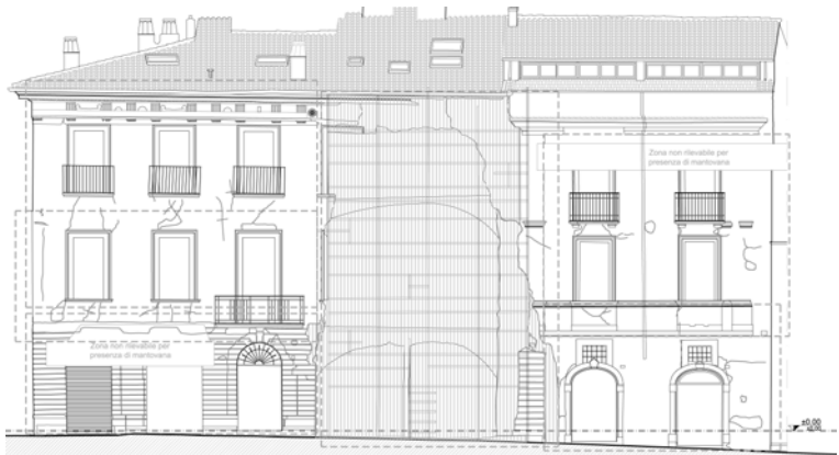
Figura 2. Palazzo Ventura a L'Aquila: il crollo di parte del fronte su via Roma
