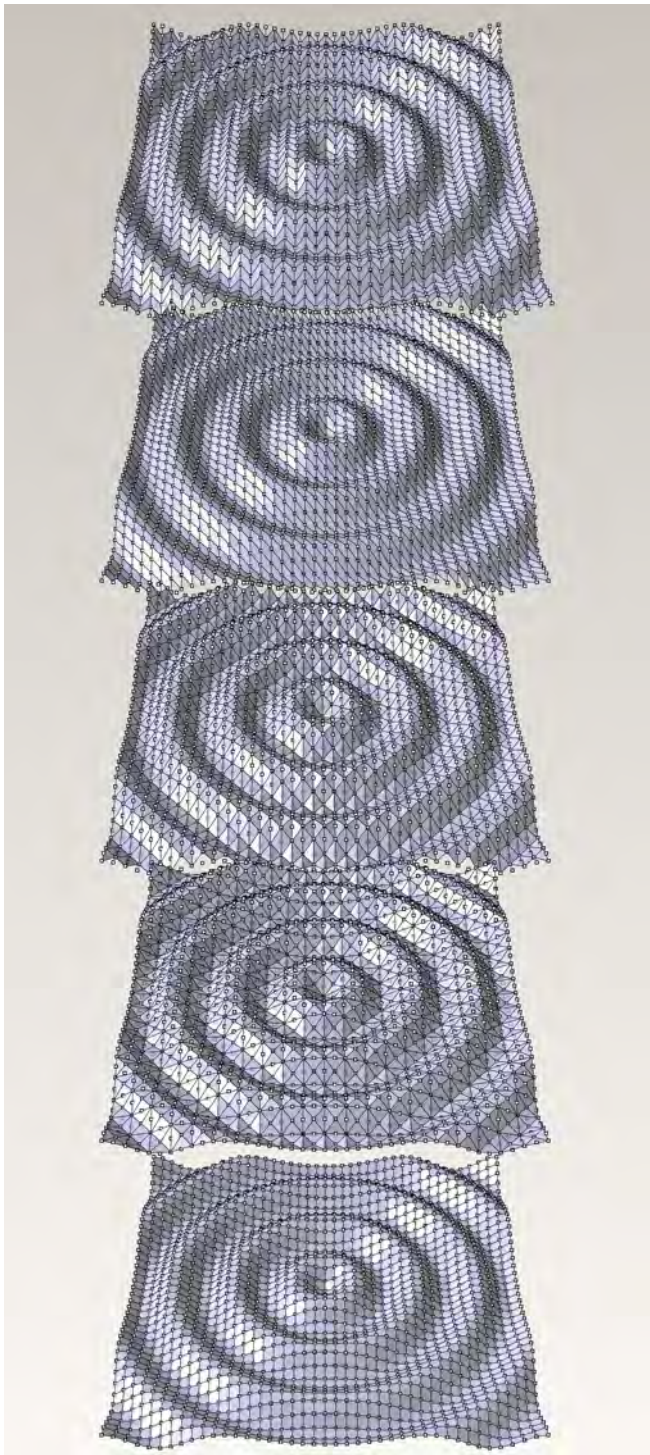
IV.158/ Esempi di modalità di connessione dei nodi di una griglia.
