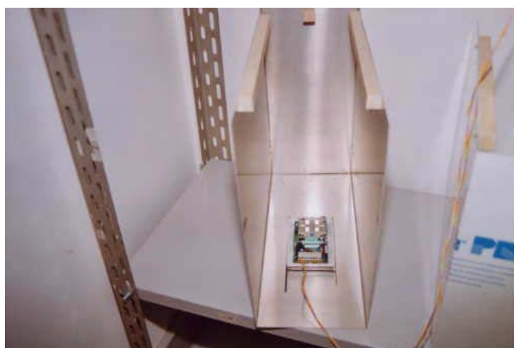
Figura 1 Alloggiamento del radar sul fondo dell'elemento
