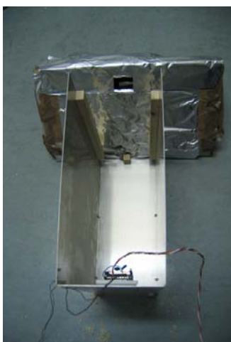
Figura 4. Schermatura del metronomo, posizione dell'apparato e finestra di acquisizione
