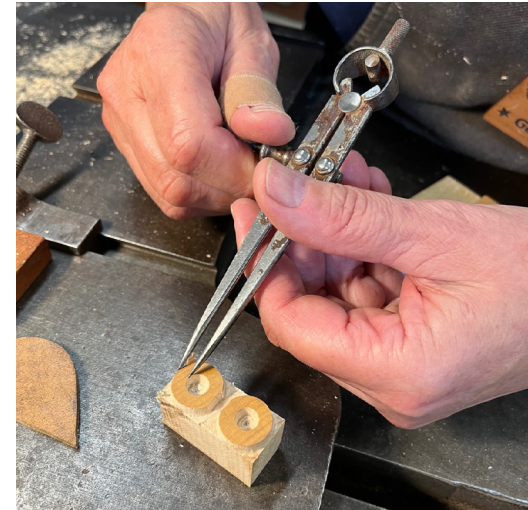
08 Misurazione della superficie di stampa della lettera "O" mediante un calibro a compasso, per il corretto l'impostazione del corretto heft
