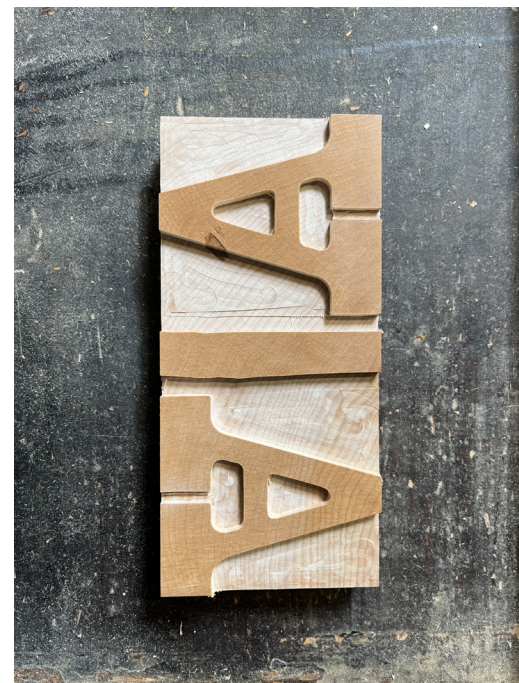
10 Caratteri fresati prima dell'asportazione del legno in eccesso e della lavorazione manuale al tavolo di rifinitura
