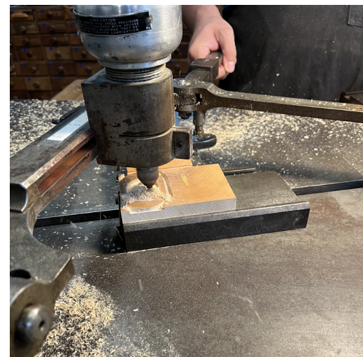
06 Tracciatore e punta mentre descrivono l'interno di un pattern
