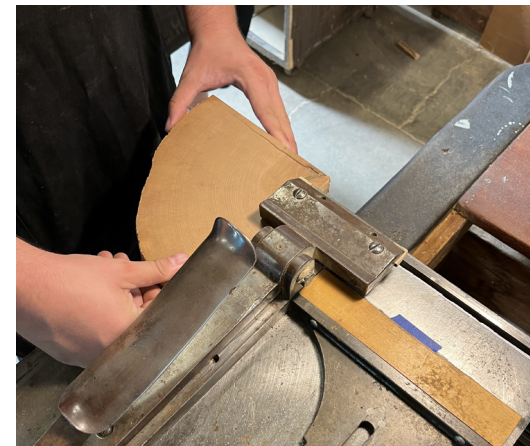
04 Taglio in blocchi con una sega circolare e rimozione degli eventuali difetti come crepe, nodi e fessurazioni
