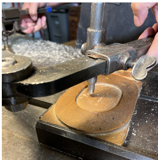
05 Mandrino con fresa in azione mentre asporta il truciolo dal blocco di legno
