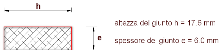
Figura 8.20. Dimensioni del giunto siliconico nell'esempio in esame.
