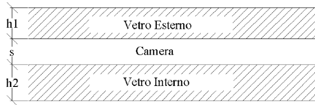
Figura 6.19. Sezione di un elemento di vetro-camera.
