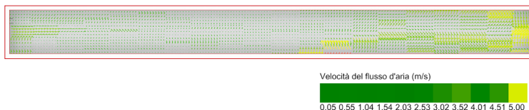
Figura 6.30 Caso A2_L30_W2.5_H2.5 - Distribuzione della velocità del flusso dell'aria (m/s) nel modello baseline. Fonte: simulazioni CFD svolte da Mitrik K. ottenute utilizzando Butterfly nell'ambiente Ladybug Tools (un plugin per Rhinoceros).
