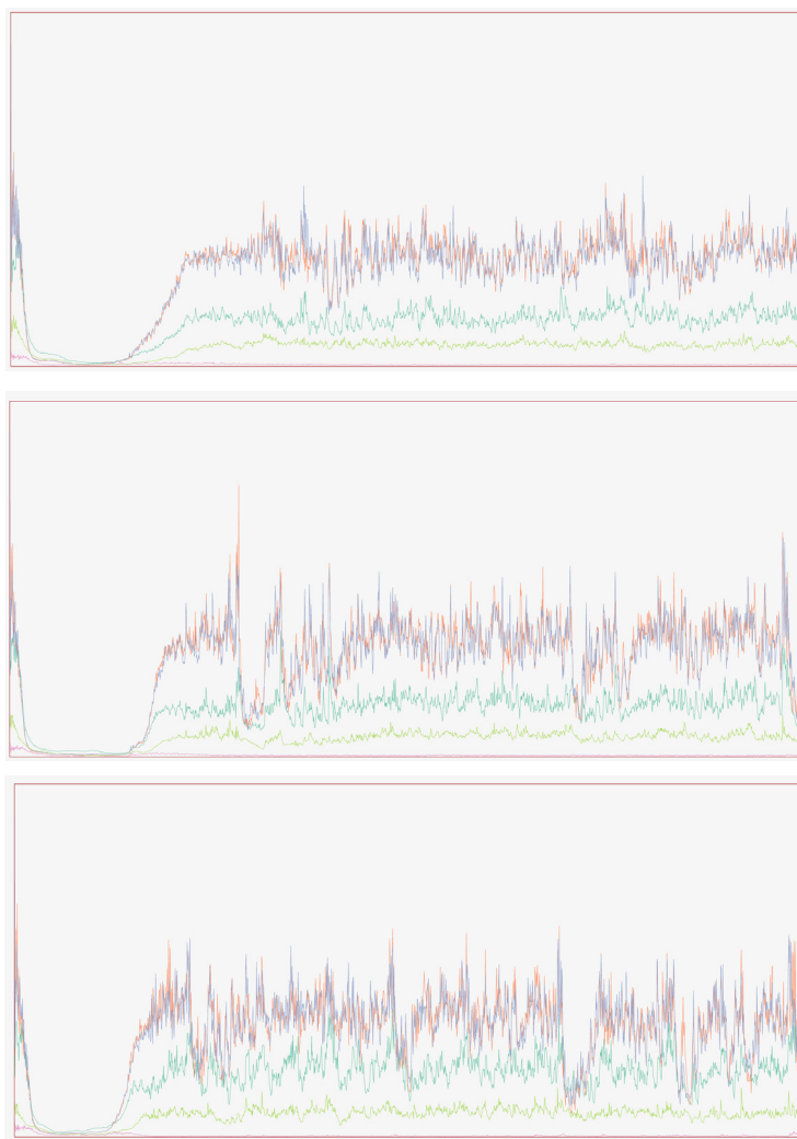
Grafico 6.9 Confronto dei profili longitudinali di velocità dell'aria, pressione e temperatura lungo il condotto per i casi C4_L80_W2_H2_V0.5_A1, C5_L80_W2_H2_V0.5_A2, C6_L80_W2_H2_V0.5_A4, ottenuti variando l'apertura di ingresso (Area apertura (1m 2 - 2m 2 - 4m 2 ). Fonte: K. Mitrik
