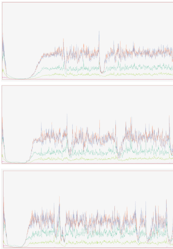
Grafico 6.8 Confronto dei profili longitudinali di velocità dell'aria, pressione e temperatura lungo il condotto per i casi C1_L80_W2_H2_V0.3_A1, C2_L80_W2_H2_V0.3_A2, C3_L80_W2_H2_V0.3_A4, ottenuti variando l'apertura di ingresso (Area apertura (1m 2 - 2m 2 - 4m 2 ). Fonte: K. Mitrik
