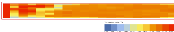
Figura 6.31 Caso A2_L30_W2.5_H2.5 - Distribuzione della temperatura (°C) nel modello baseline. Fonte: simulazioni CFD svolte da Mitrik K. ottenute utilizzando Butterfly nell'ambiente Ladybug Tools (un plugin per Rhinoceros).
