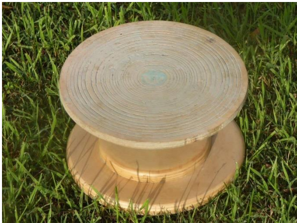
Fig. 121 Esempio di torniello in legno che può dare l'idea di un supporto che ruoti e che faciliti la modellazione del testello.
