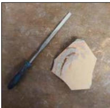
**Fig. 65** Fase di limatura e rimozione della vernice da uno dei campioni con lima diamantata.
