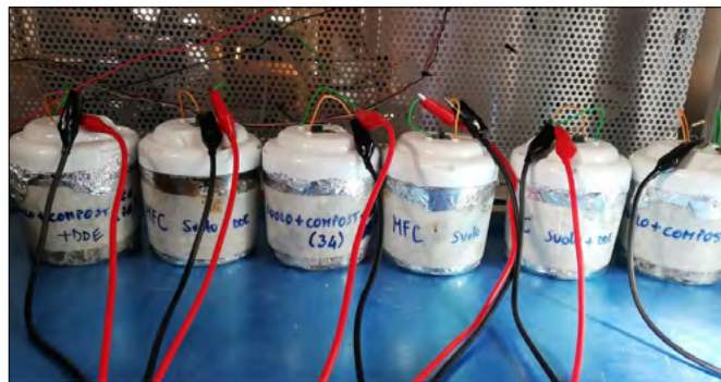
FIGURA 2. Allestimento TMFC per la rimozione del DDE.
