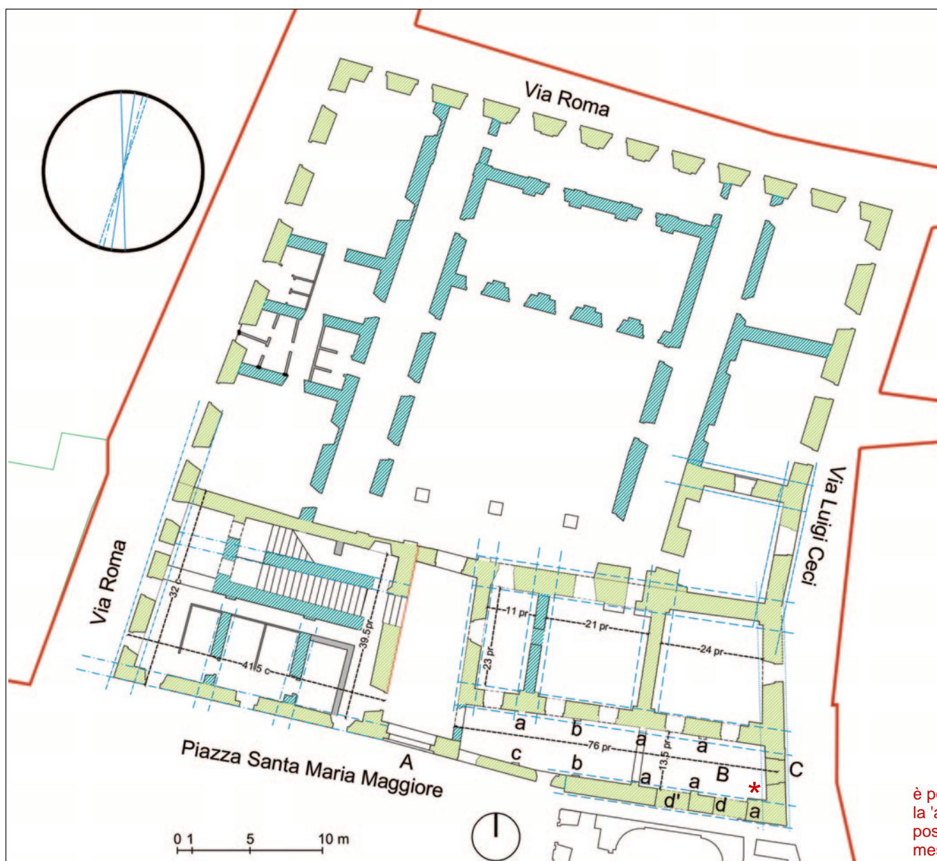
15. Studio dell'impianto architettonico di palazzo Conti Gentili. Sono in particolare analizzati gli allineamenti murari, gli spessori murari e la metrologia. La campitura verde indica lo spessore compreso tra 100 e 120 cm, la campitura azzurra, uno spessore compreso tra 80 e 100 cm, la campitura grigia uno spessore inferiore a 70 cm. Le unità di misura sono indicate con l'abbreviazione 'pr' se indicano piedi romani, con l'abbreviazione 'c' se indicano i cubiti. Sono altresì evidenziati con le lettere A, B, C gli elementi che mostrano caratteristiche architettoniche riferibili al medioevo, in particolare A indica il portale riferito alla fine del XIII secolo e trasportato da via Ceci, B indica lo spazio voltato con il fronte del primo impianto, C la muratura riferibile alla fine del XIII. Con le lettere a, b e c le diverse tipologie di capitello di imposta delle volte esistenti e con le lettere d e d' gli archi tamponati
