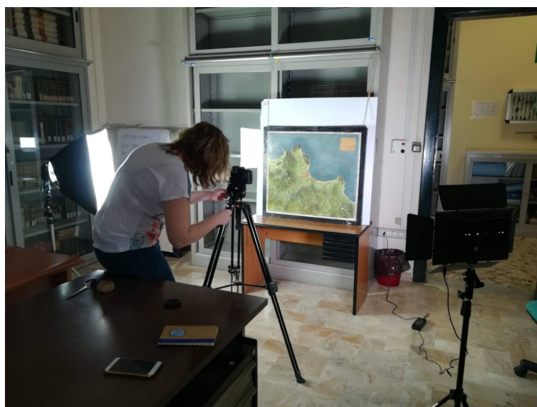
Fig. 4 - Rilievo fotografico per elaborazione fotogrammetrica
