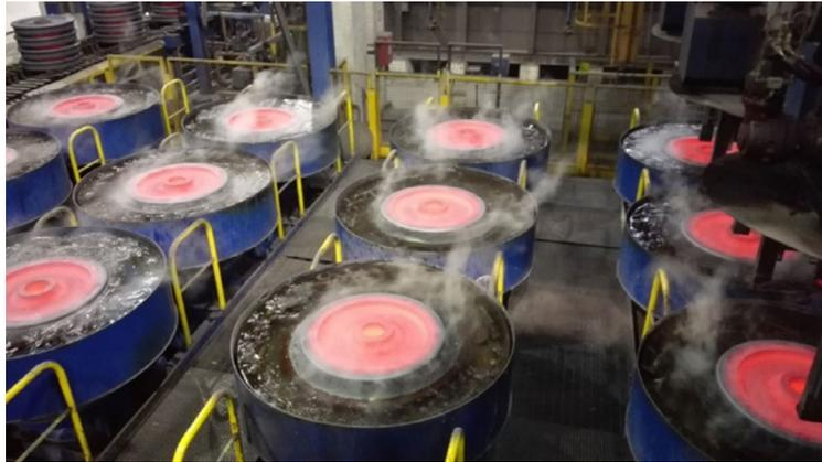
**Fig.1** - RTrattamento di tempra differenziale (Rim Chilling) presso Lucchini RS.
