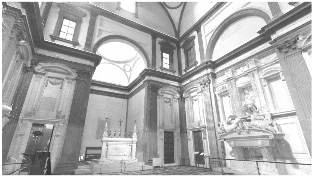
Fig. 3. Interno della Sagrestia Nuova. Nuvola di punti 3D da acquisizione scanner Faro Focus 3D.
