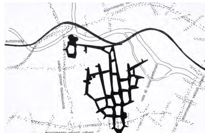
fig. 3.21 - Diagramma della rete di circolazione pedonale e del raccordo con lo scorrimento veicolare, Berlin Hauptstadt, 1957, A. Smithson, in *The Charged Void: Urbanism*, p. 47.
