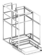
Figura 7. Particolari costruttivi dei nuovi poli liturgici realizzati con struttura metallica scatolare e rivestimenti in marmo.
