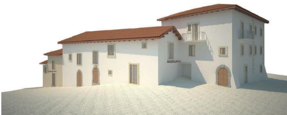
*Fig. 6.17 – Modello dettagliato realizzato in Rhinoceros Grasshopper a partire da nuvola di punti e successiva visualizzazione nel software Archicad con riconoscibilità semantica degli elementi e caratterizzazione dei materiali. Aggregato di Terracino. Elaborazione ed immagine dell'autore.*
