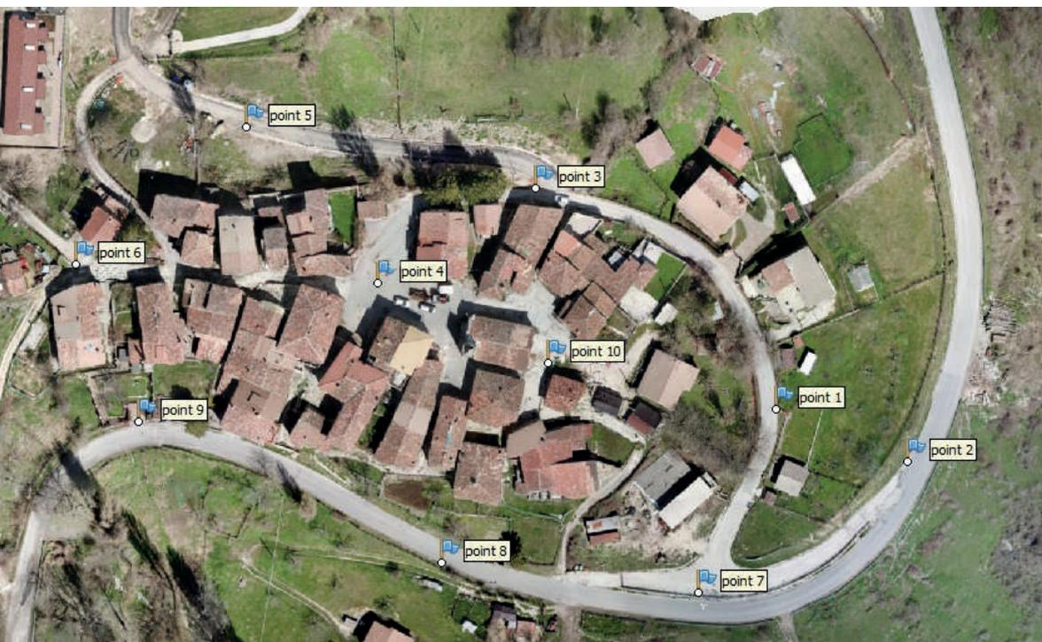
*Fig. 6.5 – Nuvola di punti derivante da fotomodellazione in seguito ad una campagna di rilievo effettuata con sistema UAV e fotocamera integrata. I punti contrassegnati sono i GDP (Ground Control Point), che hanno consentito di scalare e georeferenziare il progetto nel software Photoscan. Elaborazione Leonardo Paris e Carla Nardinocchi.*
