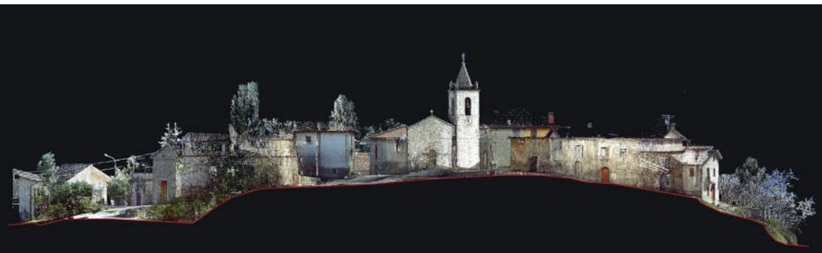
*Fig. 4.2 – Sezione di livello urbano di una frazione di Accumoli. La restituzione è il risultato di un rilievo integrato con LS e aerofotogrammetria da drone. Restituzione ed immagine dell'autore.*
