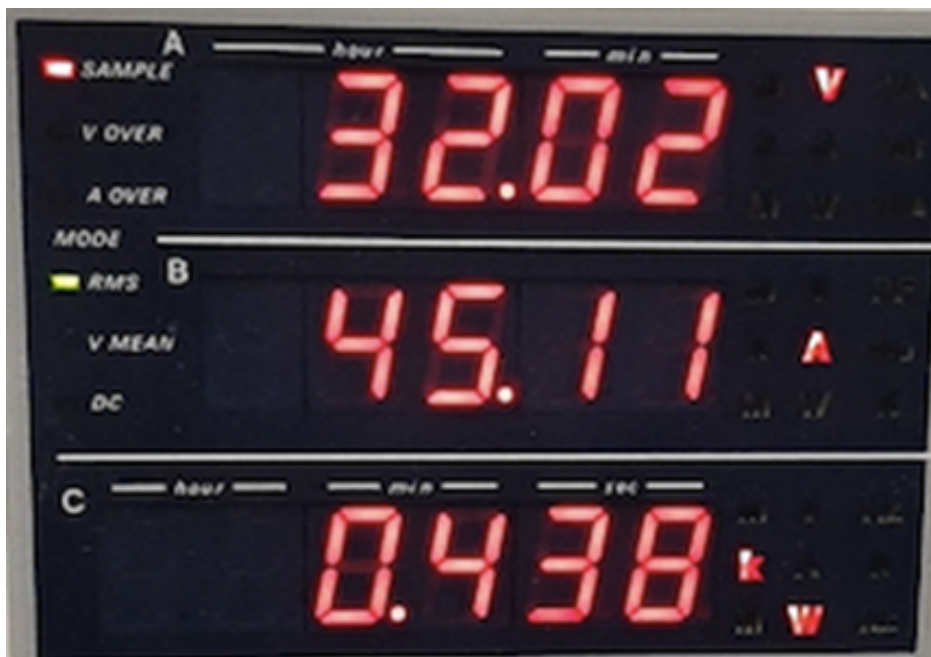
Figura 2.16: Prova in cortocircuito - Valori misurati di potenza, tensione e corrente al primario
