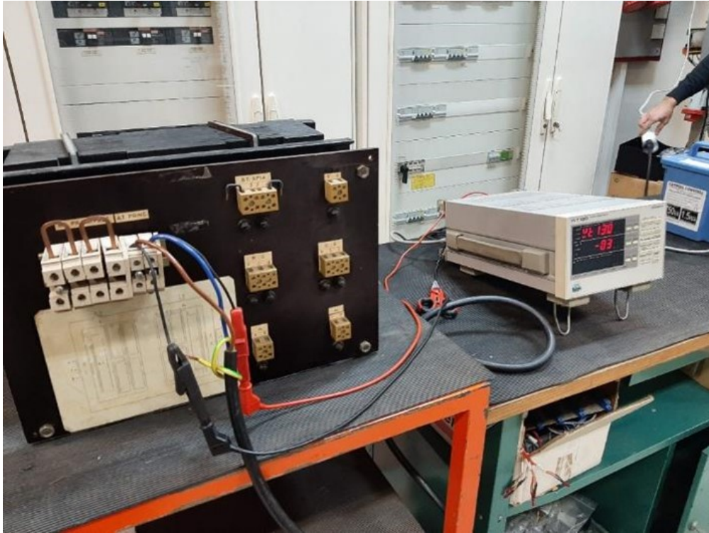
Figura 2.11: Prova a vuoto – schema reale di configurazione della misura
