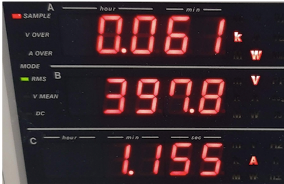
Figura 2.12: Prova a vuoto – Valori misurati di potenza, tensione e corrente al primario
