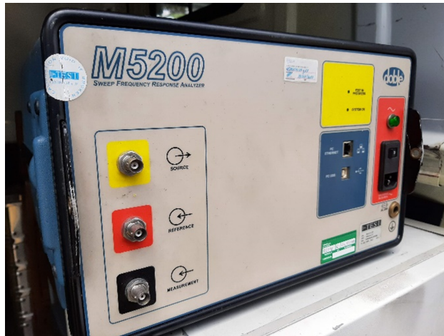
Figura 9.4: DOBLE tipo M5200
