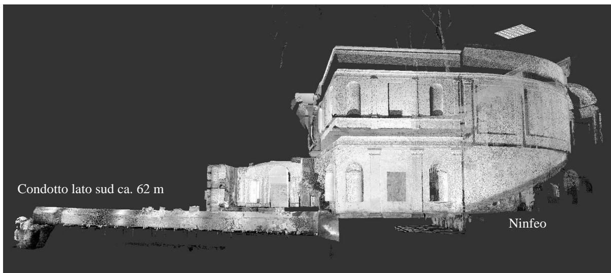
Fig. 111. Prospetto dell'*Aqua Virgo* rispetto al palazzo e al ninfeo. Vista da nord del braccio a valle. Il canale e il ninfeo si sviluppano alla stessa quota. Elaborazione Reconstructor v4.3.2.
