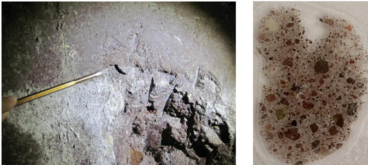
Fig. 261. Punto di prelievo del campione VIR13 e dettaglio della sezione sottile di VIR13 su vetrino portaoggetti.
