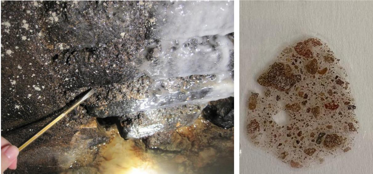
Fig. 206. A sinistra, prelievo del campione VIR1 dalla malta di allettamento tra i laterizi di una bocchetta. A destra, sezione sottile del campione VIR1 su vetrino portaoggetti.
