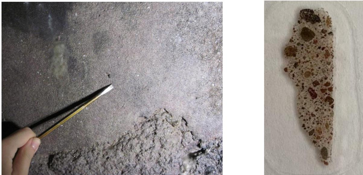
Fig. 248. Dettaglio del punto di prelievo di VIR10 e a destra sezione sottile del campione su vetrino portaoggetti.
