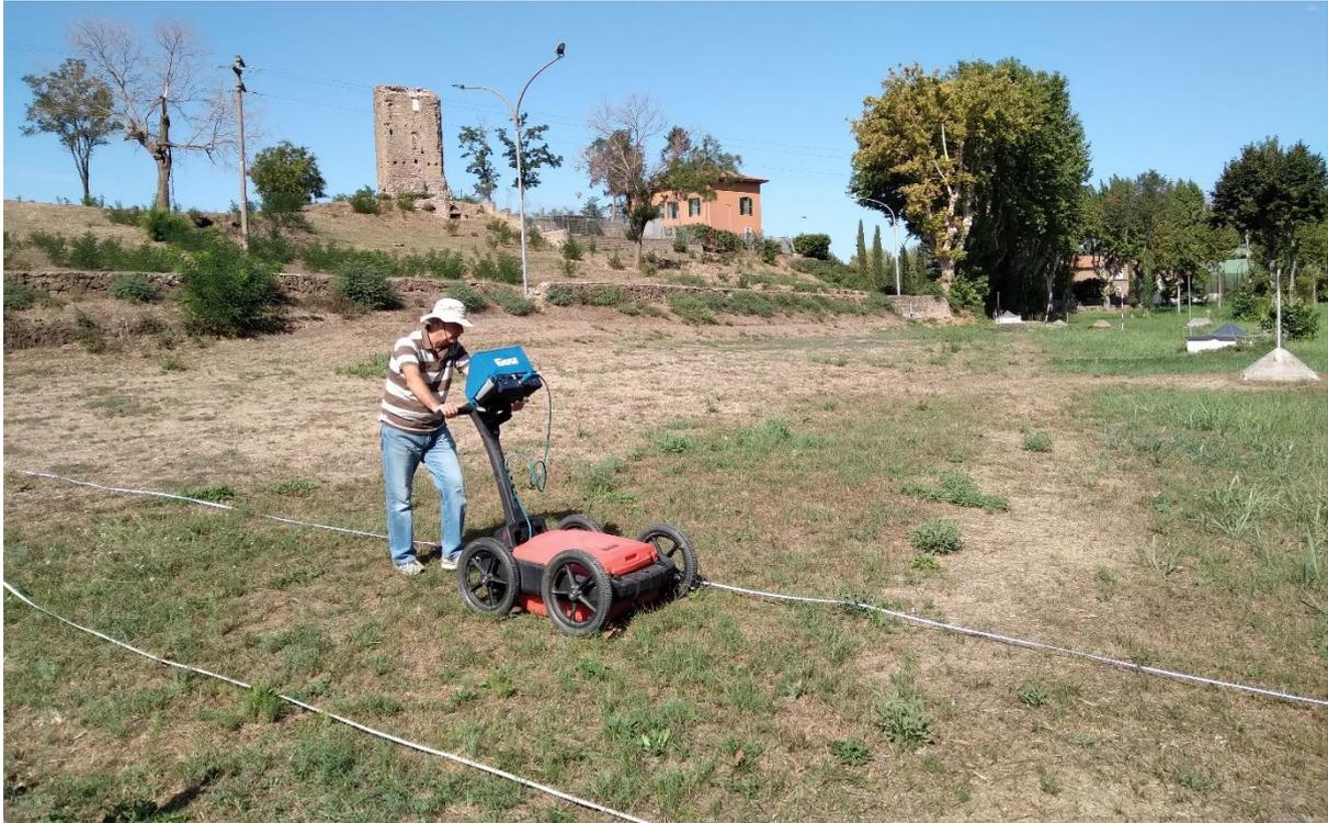
Fig. 196. Tracciamento del secondo profilo orizzontale con georadar dotato di antenna da 270 MHz.
