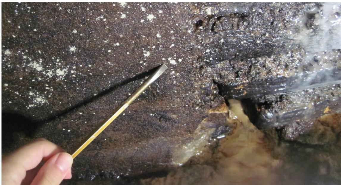
Fig. 215. Prelievo del campione VIR2 dalla malta di rivestimento a monte della prima bocchetta di presa.
