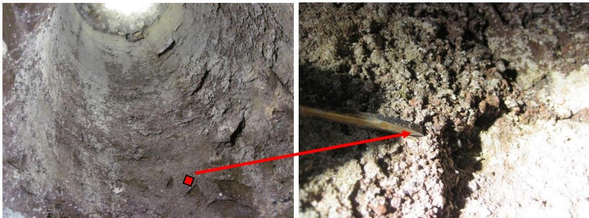
Fig. 220. A sinistra pozzetto circolare con indicazione del punto di prelievo. A destra dettaglio del campionamento.
