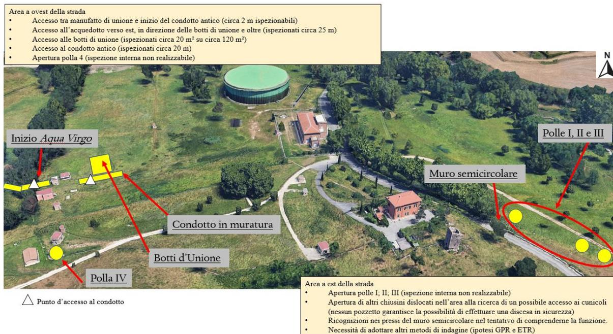
Fig. 43. Dettaglio di un'area delle sorgenti con indicazione delle principali attività di ricerca svolte *in situ*. In giallo i principali elementi connessi all'acquedotto (rettangolo: speco ipogeo; cerchio: polla attiva; quadrato: botti di unione). Elaborazione da Google Earth (2021).
