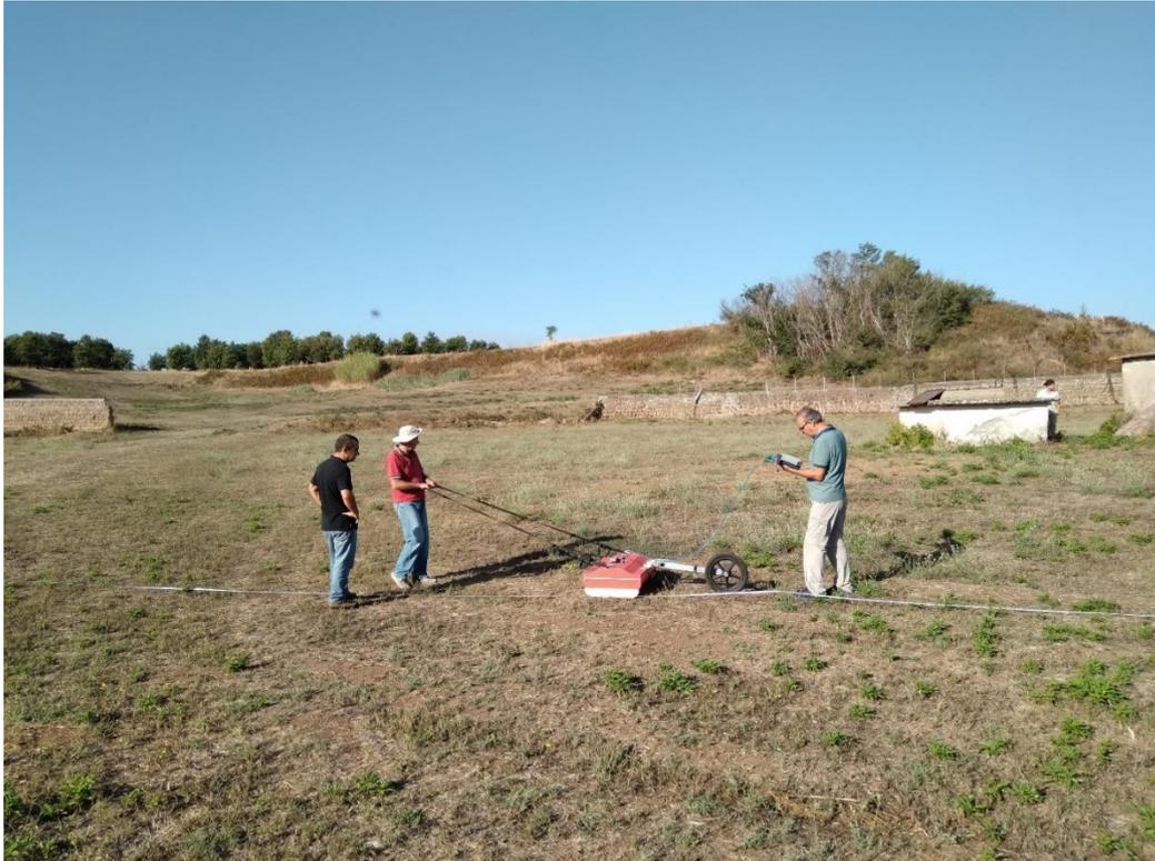
Fig. 201. Esecuzione del test 2 con antenna da 100 MHz.
