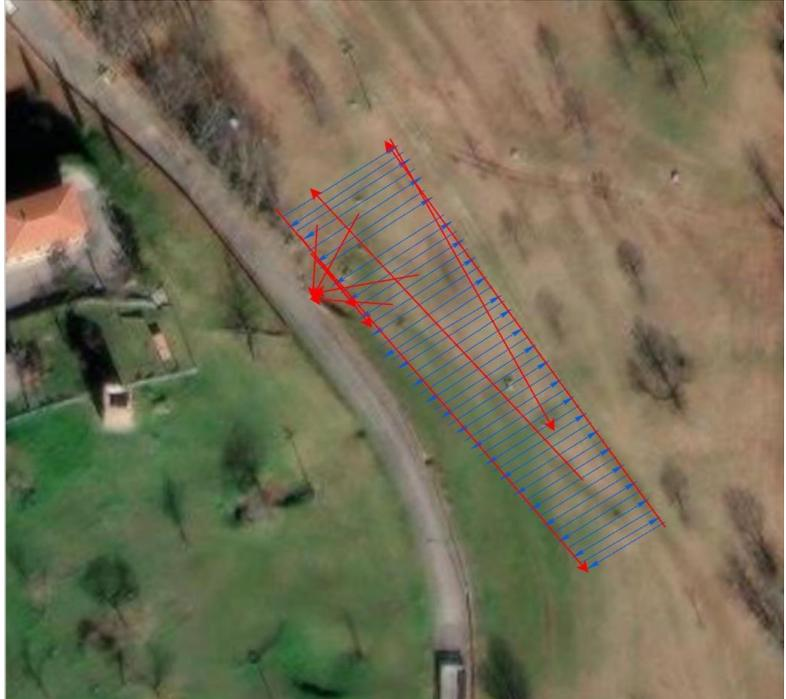
Fig. 197. Profili georadar (sn) e loro trasposizione in Google Earth (dx). Elaborazione a cura di G. Leucci.
