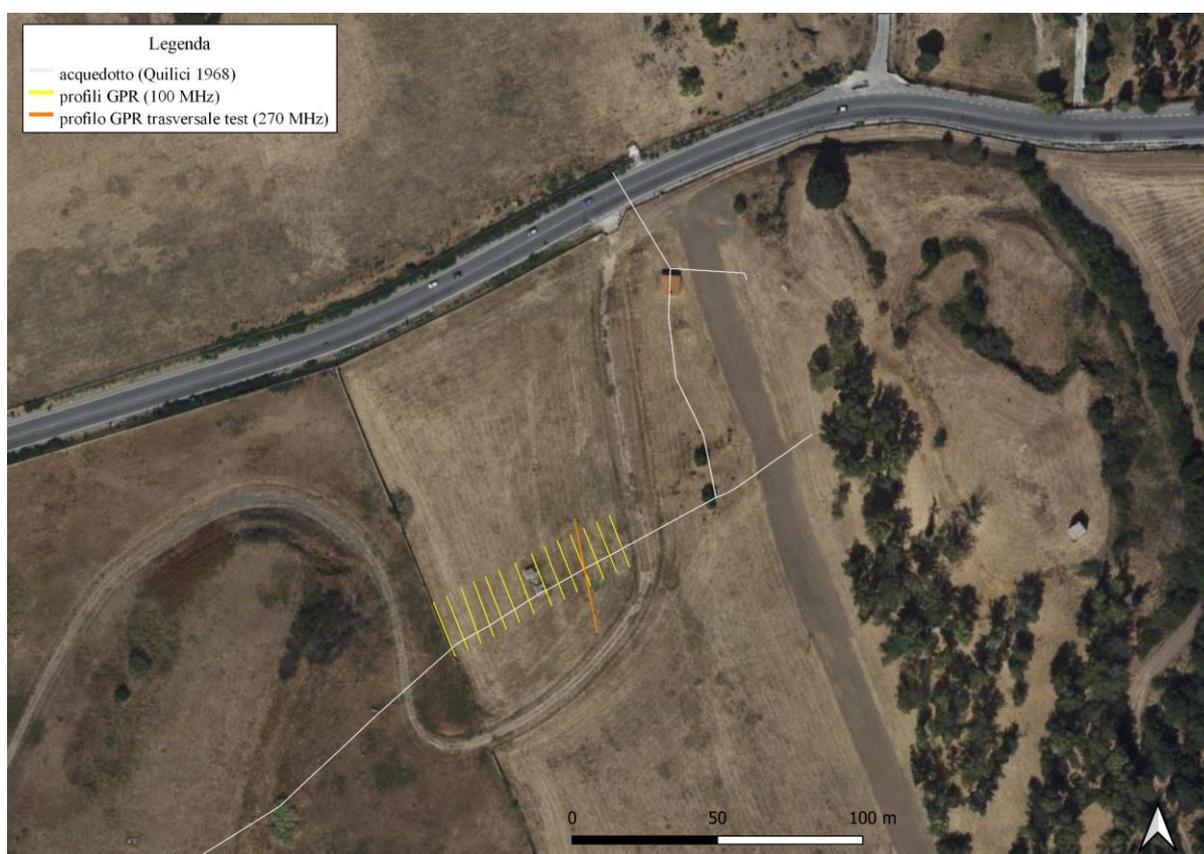
Fig. 202. Profili georadar effettuati con antenna da 100 MHz (in giallo) e test 2 (in arancione) in rapporto all'acquedotto. Elaborazione QGIS su base Bing Satellite.
