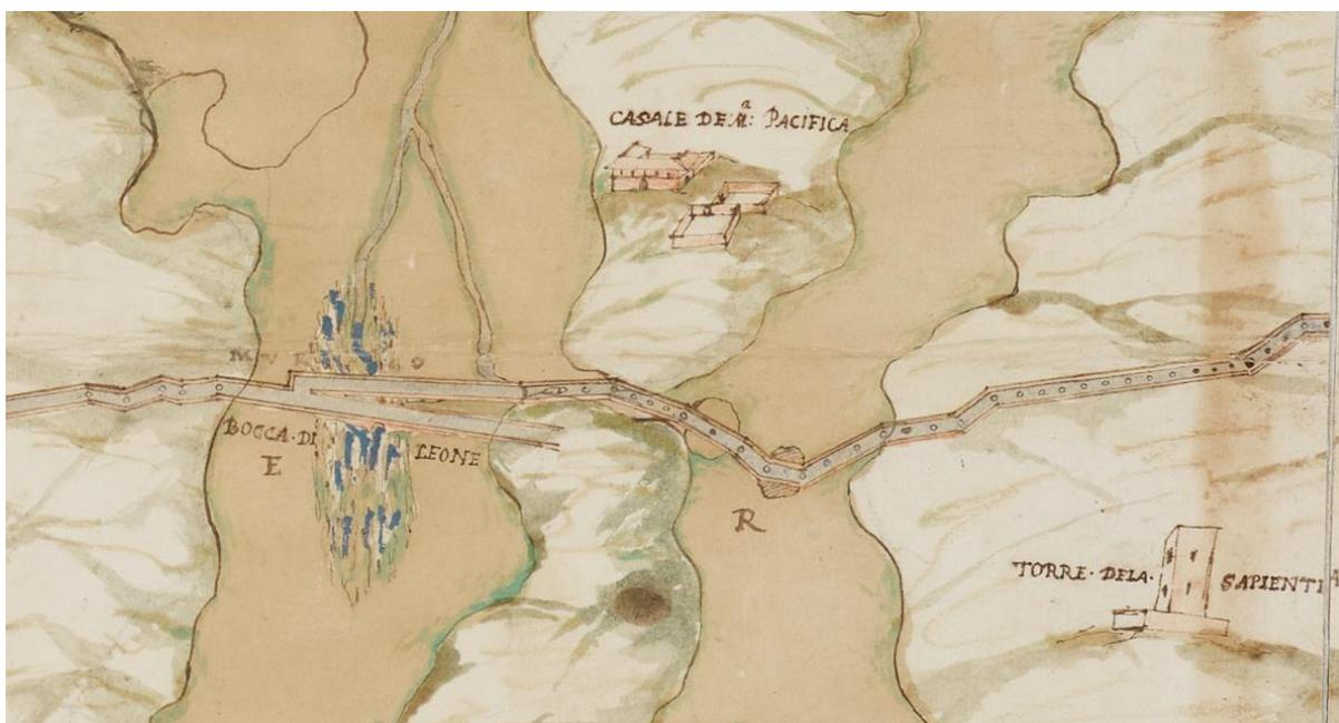
Fig. 81. Dettaglio dell'*Aqua Virgo* in località Bocca di Leone. L'acquedotto, in corrispondenza dello scavalcamento del fosso di Centocelle, è accompagnato dalla didascalia "muro" a conferma del passaggio su sostruzione. Da GDSU, inv. 4236A.
