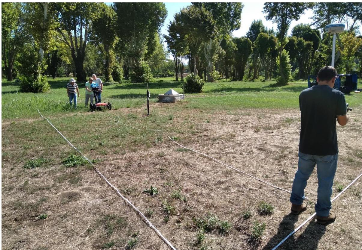
Fig. 195. Preparazione del grid 1. Impostazione della strumentazione e posizionamento dei punti della griglia.
