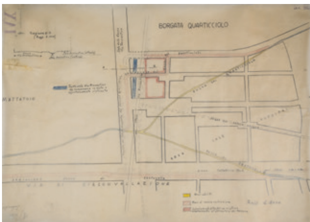
Fig. 3 – Conservazione di strada romana : a) pianta rapp. 1:2000 e sezione rapp. 1:1000. L'elaborato riporta i "Fossi aboliti", i "Fossi di nuova costruzione" e la "Sistemazione abolita per un migliore adattamento all'altimetria del terreno", il "Tratto della via Prenestina da conservare in vista e opportunamente sistemata", la "via Prenestina [attuale]", la "via Prenestina [antica]", la "Nuova via Prenestina"; b) Veduta dello stato di fatto firmata da Luigi Castellani; c) Veduta della proposta di intervento firmata da Luigi Castellani, © SBCAD, inv. 392, 395, 396.
