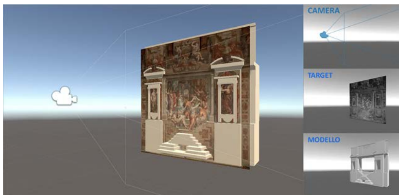
Fig. 4. Allestimento della scena virtuale per la RA: è possibile notare come il target sia rappresentato dall'opera quadraturista, il cui studio geometrico fa coincidere il piano di quadro del sistema prospettico; la camera, che corrisponde al centro di proiezione; il modello tridimensionale desunto dalla restituzione prospettica (elaborazione grafica dell'autrice).
