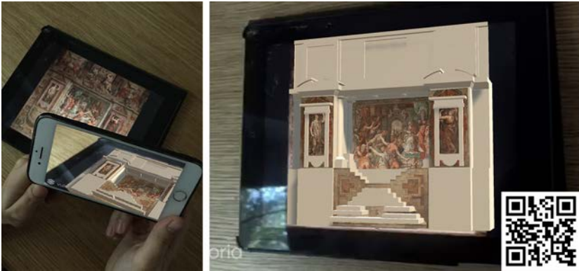
Fig. 6. Sperimentazione AR applicata alla parete ovest: all'immagine dell'affresco si sovrappone il modello geometrico implementato da texture. Il qr code se inquadrato, in questa e nelle immagini successive, riporta a brevi video che mostrano le applicazioni in funzione (elaborazione grafica dell'autrice).
