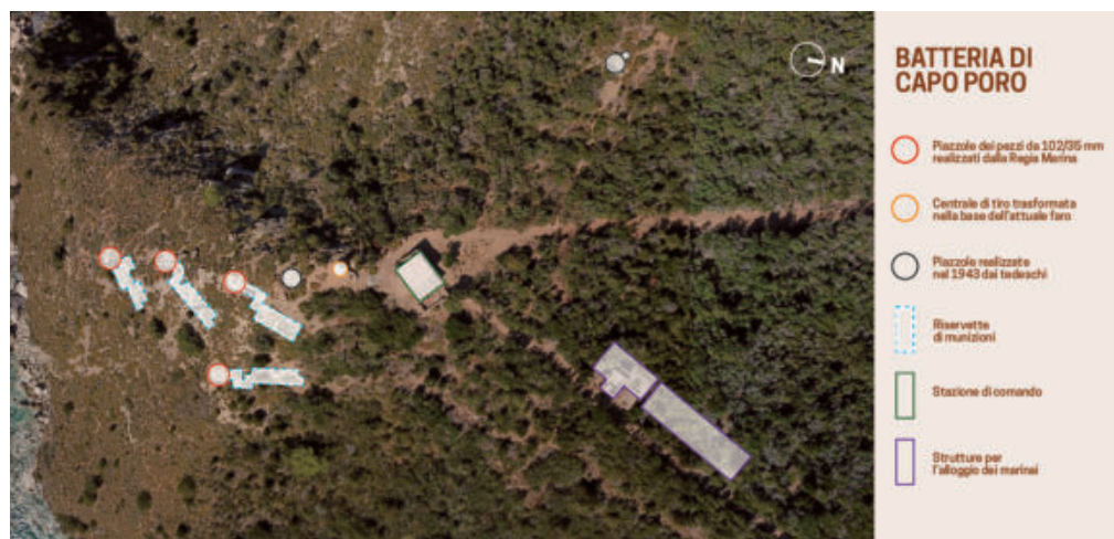
Fig. 2- Composizione della batteria di Capo Poro con indicazione della posizione dei quattro pezzi d'artiglieria e delle riservette, costruite nel 1932. Nell'immagine sono visibili, in nero, le integrazioni avvenute nel 1943 da parte dei tedeschi. Inoltre, in giallo, la centrale di tiro poi trasformata in faro (elaborazione grafica di Alexandra Fusinetti)
